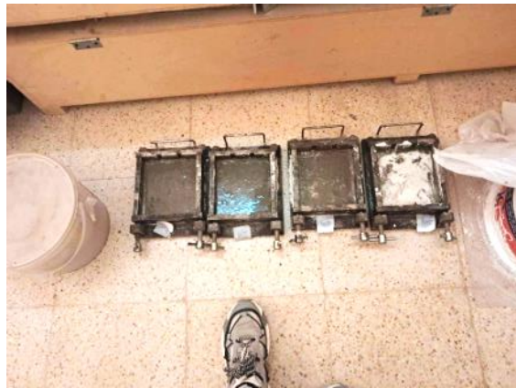
Figure-II-17. Les moules avec le mélange de chaque pourcentage.
