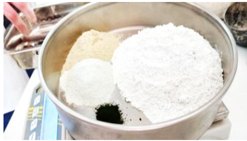
Figure-II-23. mélange ciment et poudre avec colorant
