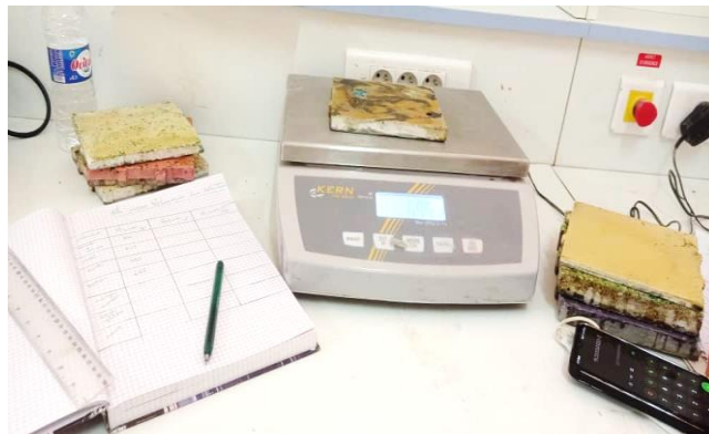
Figure-II-46. masse des carreaux
