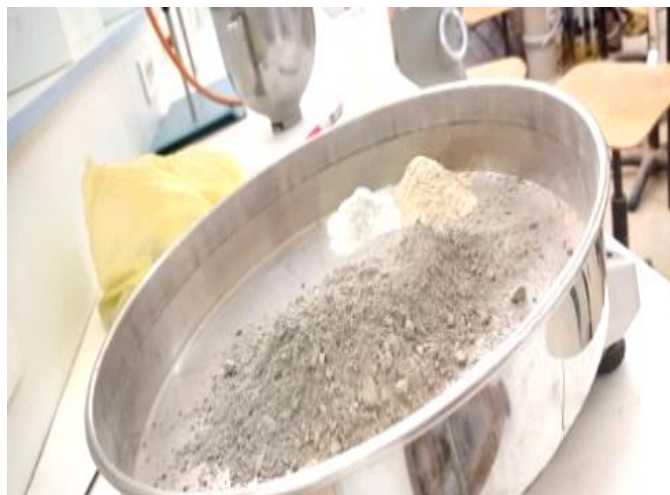
Figure-II-15. Mélange de ciment portland avec la poudre de verre
