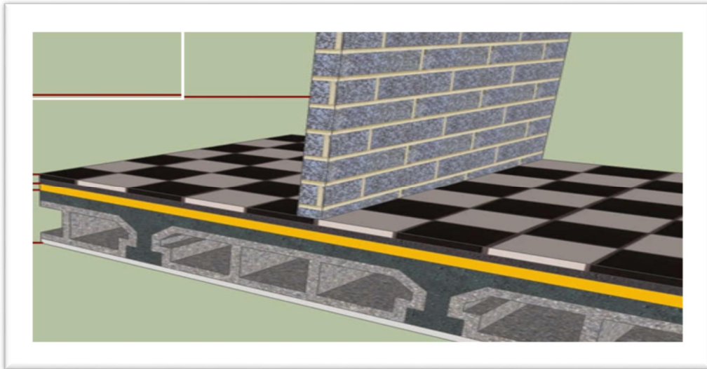
Figure 2.2. Plancher étage courant
