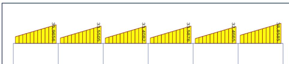
Figure V. 6 : diagramme de l'effort tranchant de la poutre murale
