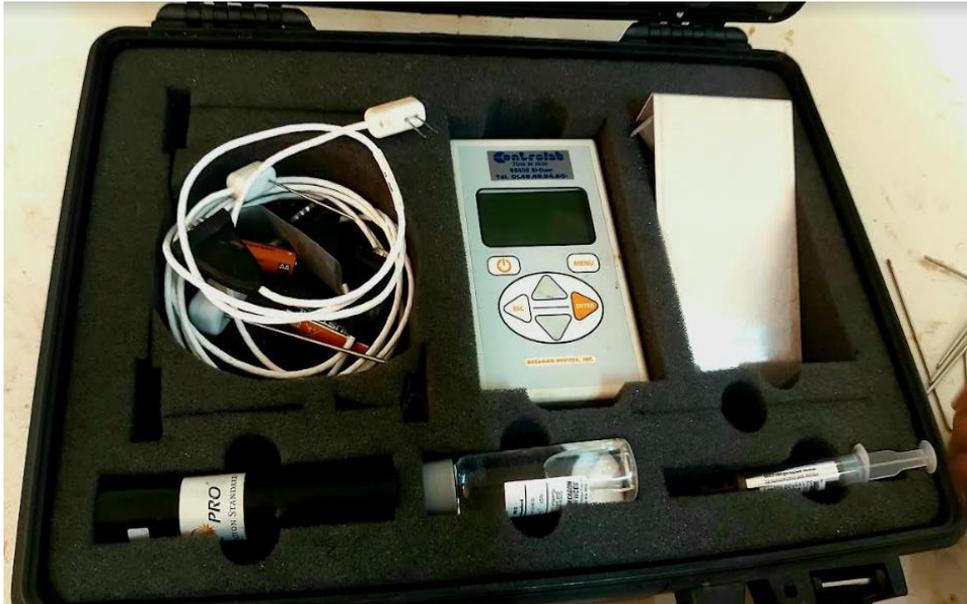
*Figure 3.11: Appareil de conductivité thermique.*
