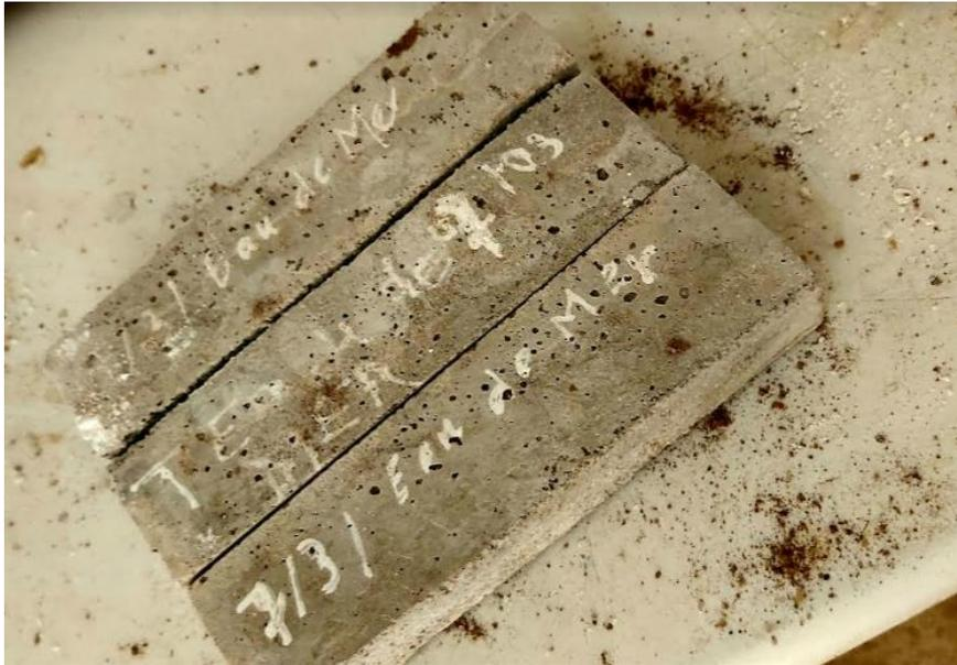
*Figure 3.7: Marquage des éprouvettes.*
