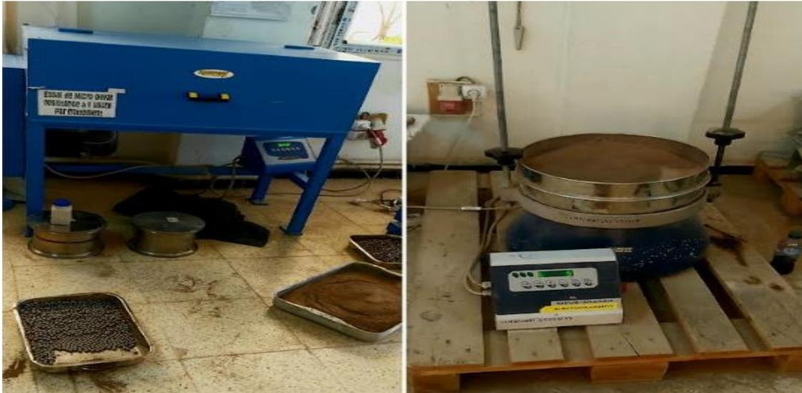
*Figure 2.19 : Appareil de MICRO DEVAL et Tamiseuse.*
