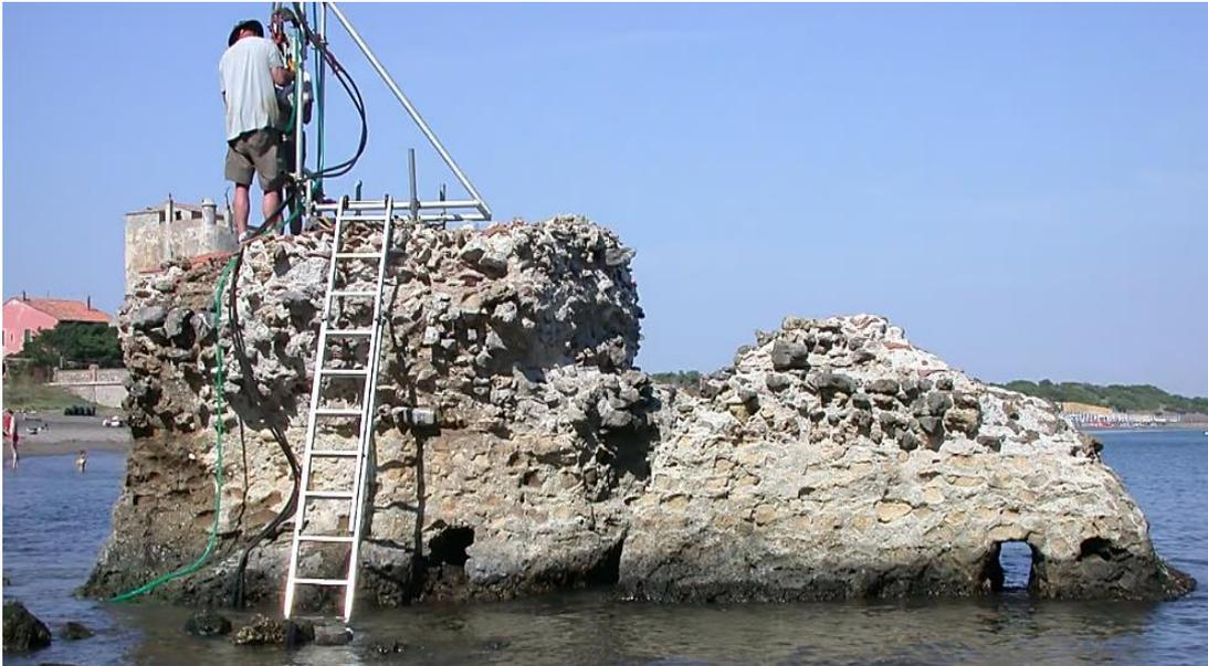
*Figure 1.9: Forage sur une structure marine à Portus Cosanus, Toscane, 2003. Photo prise par : J. P. Oleson[2].*
