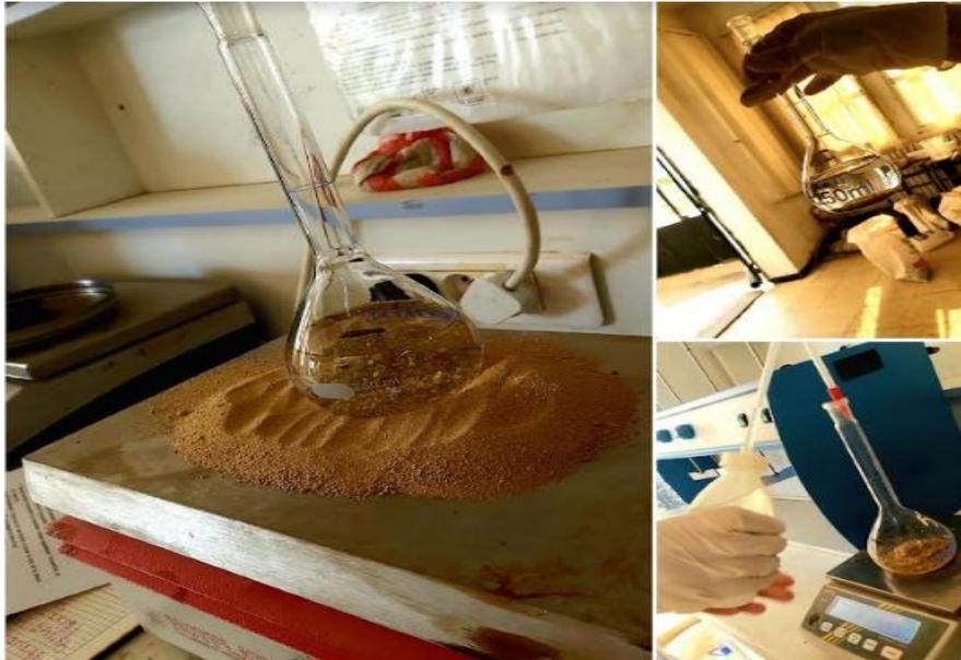
*Figure 2.10 : La masse Absolue de sable.*
