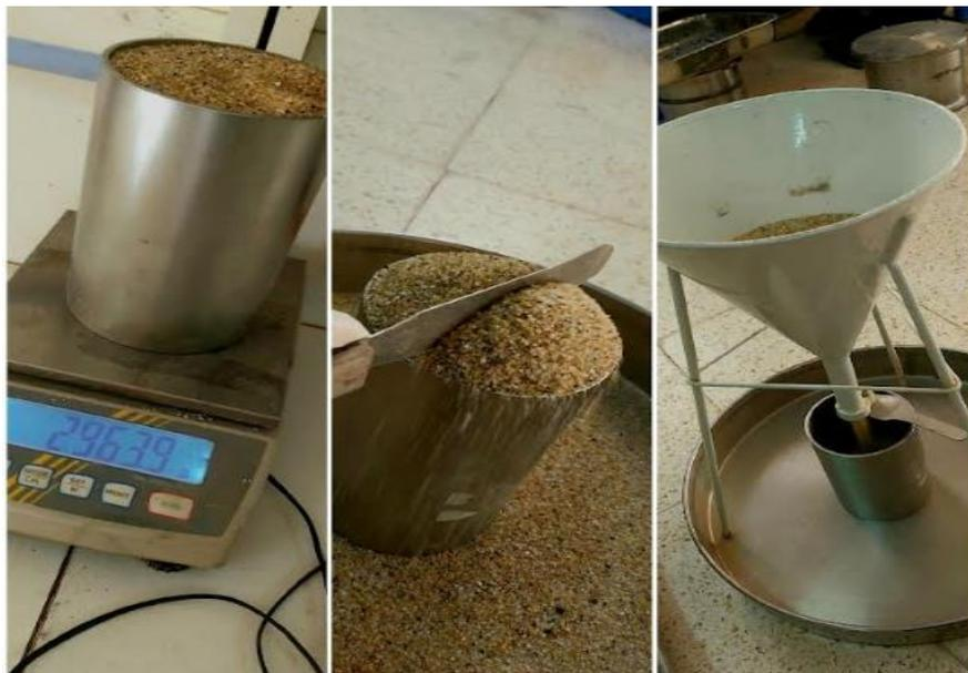
*Figure 2.9: La masse volumique Apparente de sable.*
