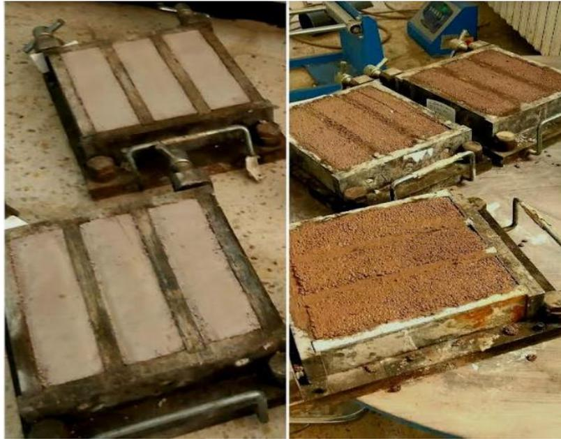
*Figure 3.3: Mortier à base de pouzzolane et chaux.*
