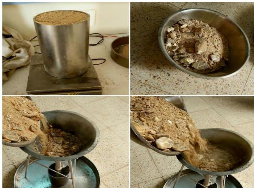
*Figure 2.24 : La masse volumique apparente de gypse.*
