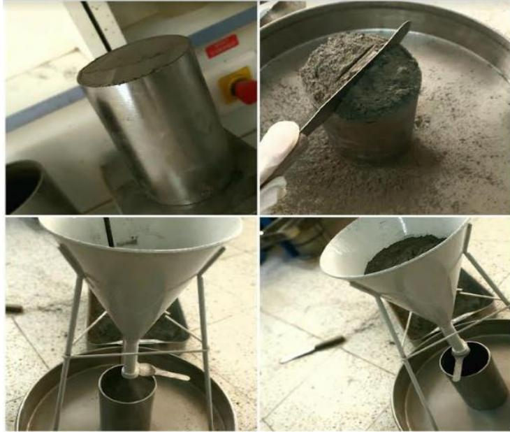
*Figure 2.7: La masse volumique apparente de ciment.*
