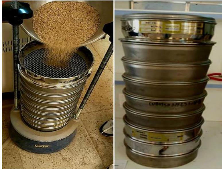
**Figure 2.11 : Essai d'Analyse granulométrique.**
