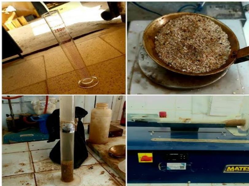
Figure 2.14 : Essai Equivalent de Sable.
