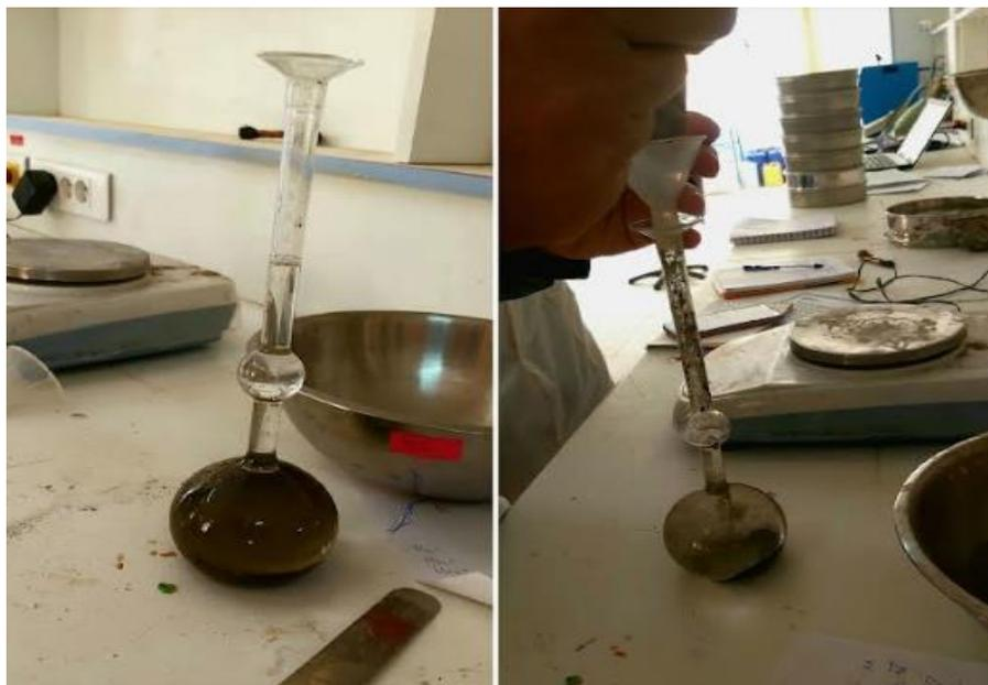
*Figure 2.8 : La masse volumique absolue de ciment.*
