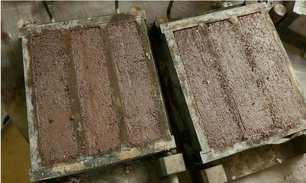
*Figure 3.5 : Les éprouvettes de mortier à l'état frais.*
