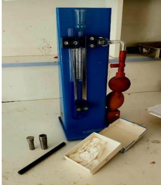
*Figure 2.3 : L'appareil de Surface Spécifique Blaine.*
