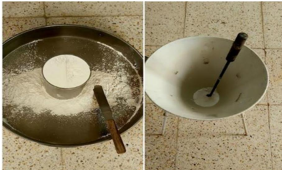
Figure 2.25 : La masse volumique apparente de chaux.
