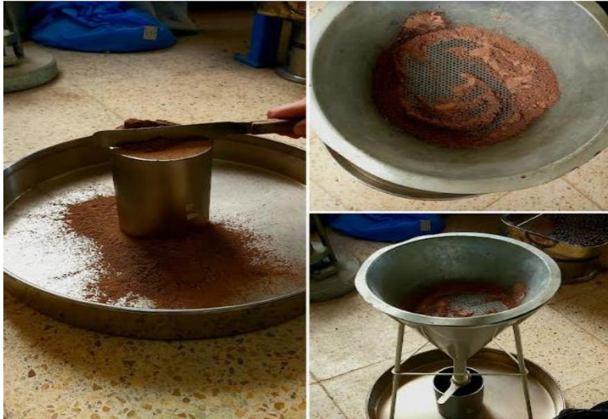
*Figure 2.20 : La masse volumique apparente de Pouzzolane.*
