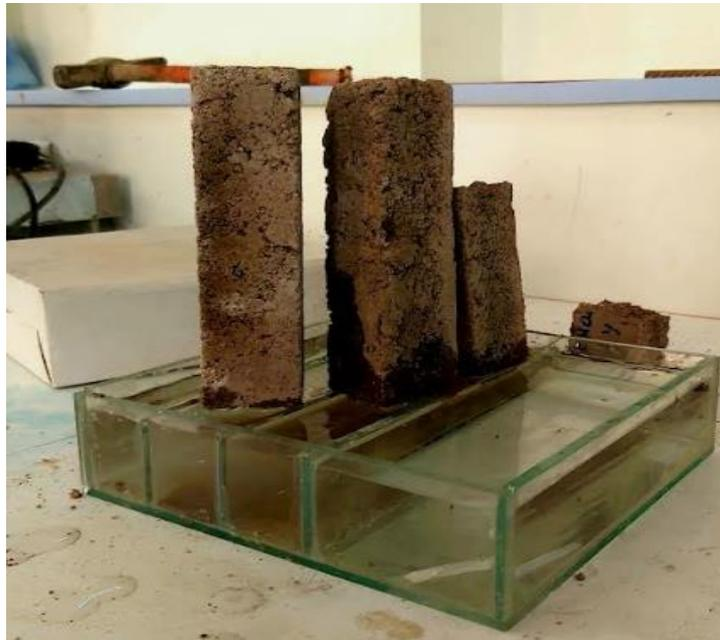
*Figure 3.10: Essai d'absorption par capillarité.*
