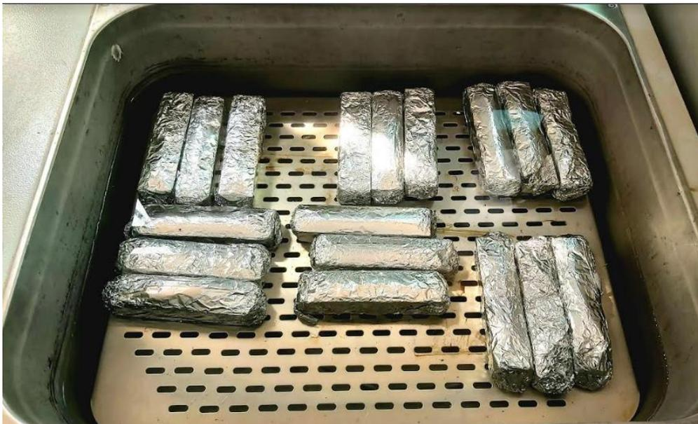
*Figure 3.6 : Les éprouvettes dans un bain-marie.*
