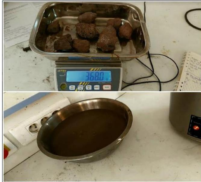
*Figure 2.5 : L'essai d'absorption.*
