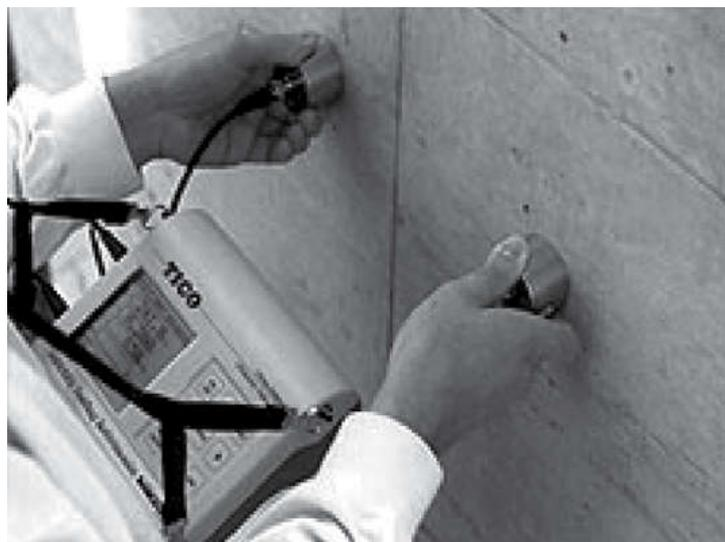
FIGURE 2. 12 TRANSMISSION EN SURFACE [1.3].
