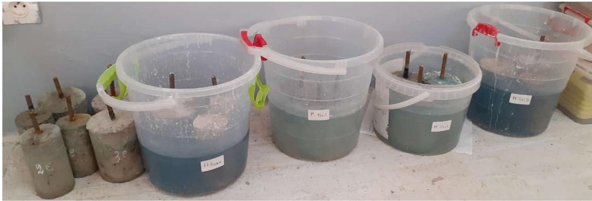
FIGURE3. 16 DIFFERENT TYPE DES MILIEUX UTILISER POUR LES EPROUVETTES PRISE PAR LES AUTEURS
