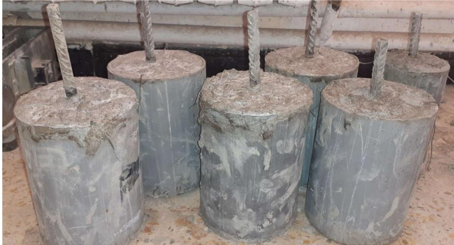
FIGURE3. 14 LE MOULAGE DES EPROUVETTES PRISE PAR LES AUTEURS
