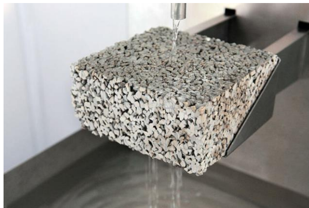
Figure 12 : échantions de béton poreux
