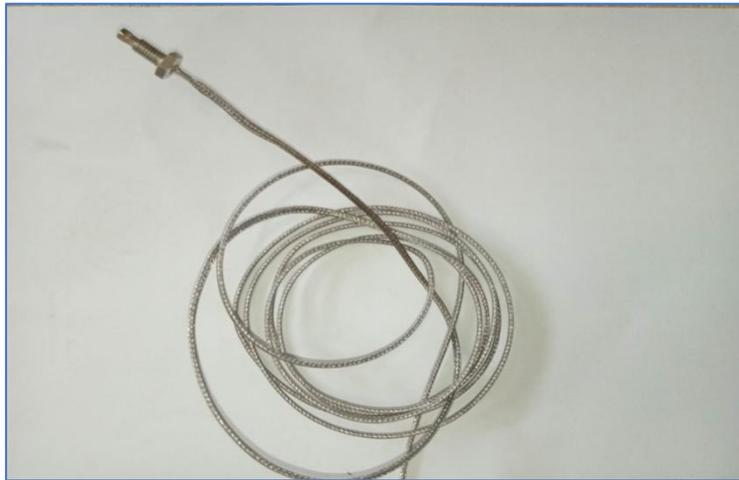
Figure 28: température thermocouple type k
