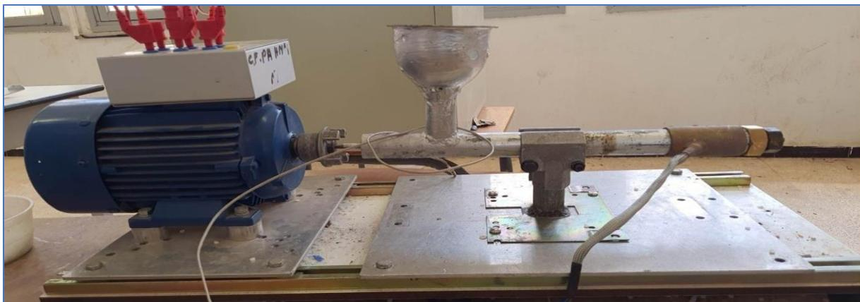
**Figure 18 : machine extrudeuse de plastique.**
