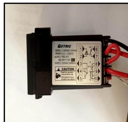
Figure 27: le schéma de câblage
