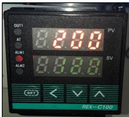
Figure 26 : Le régulateur de température
