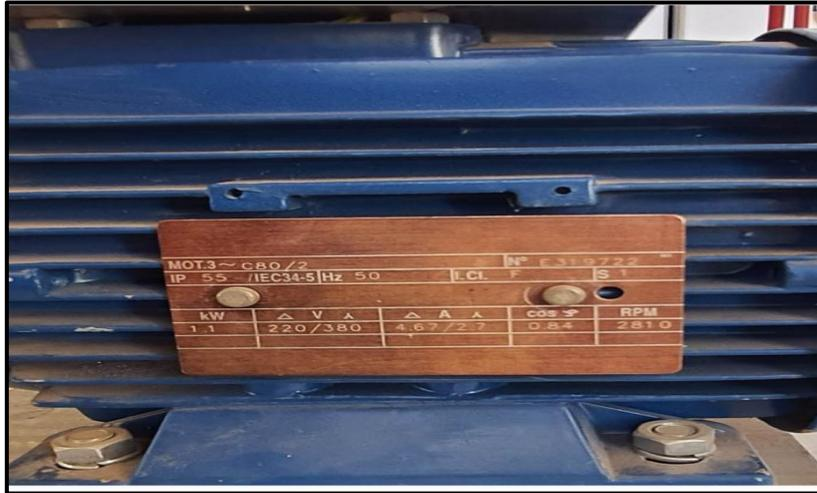
Figure 29 : la plaque signalétique de moteur
