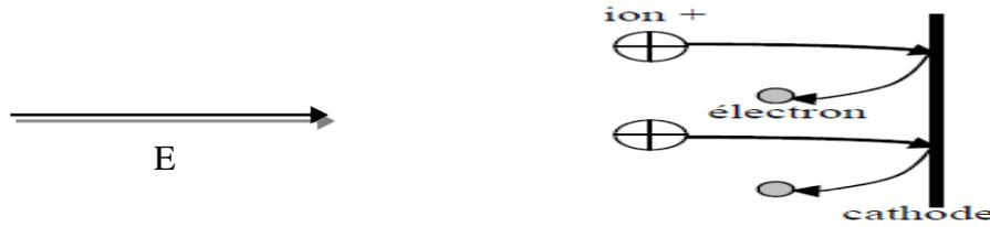
**Figure(I.2) :** *Emission d'électron secondaire par bombardement d'ion positive*
