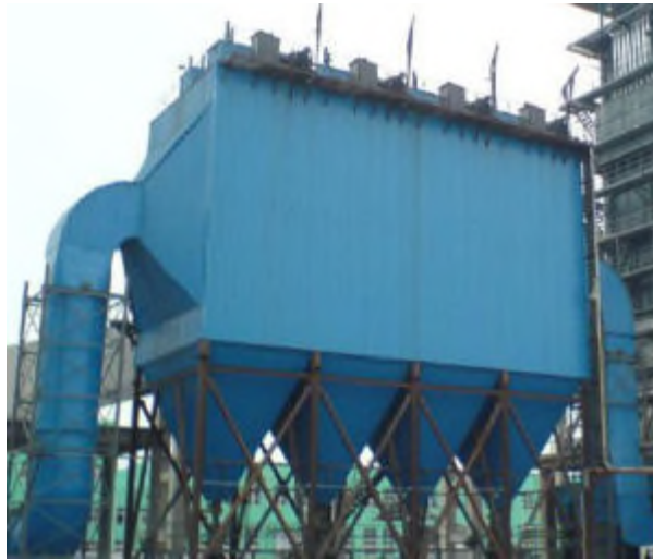
Figure (05) : Architecture des précipitateurs électrostatiques [9]
