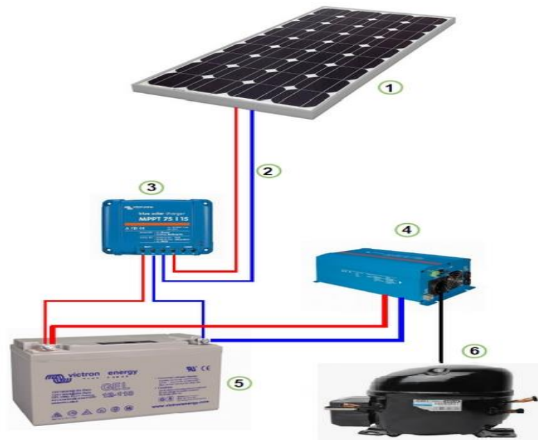
Figure .III.20: Alimentation de compresseur par l'énergie solaire.
