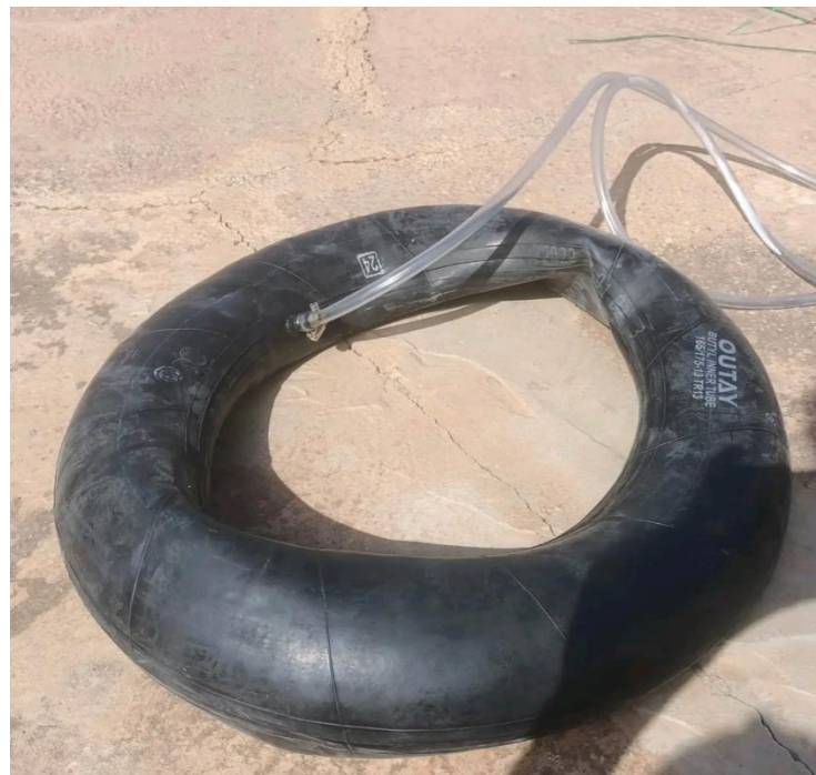
Figure.I.17 : Gonflement de chambre à air près 24h.
