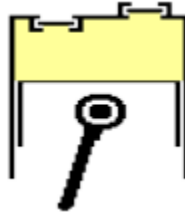
Figure.II.5: Compresseur à simple effet.
