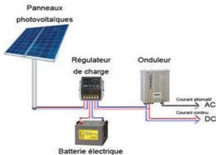
Figure.III.12: Représentation d'un système photovoltaïque autonome.
