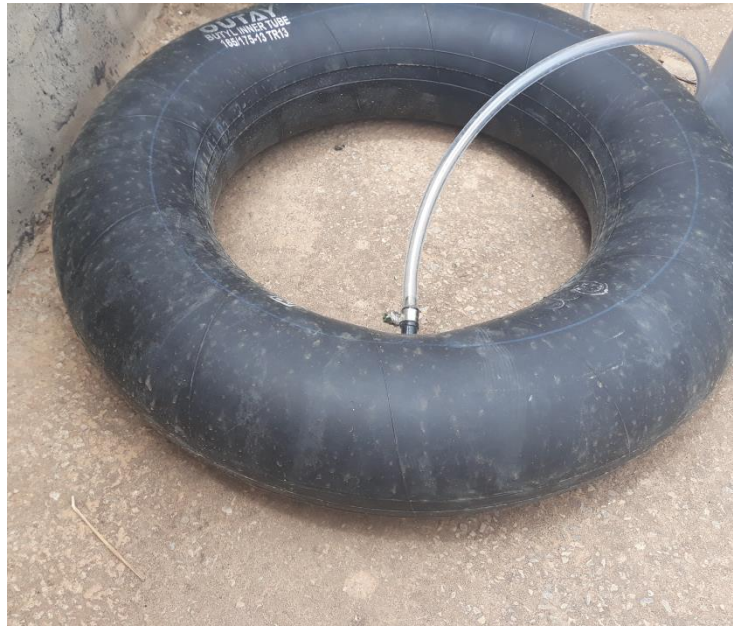
Figure.I.18 : Gonflement de chambre à air après 5 jours.
