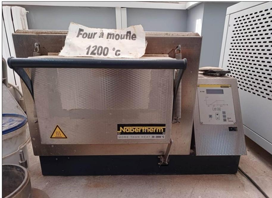
**Figure 32: Four pour séchage du sol à +de 500°C**
