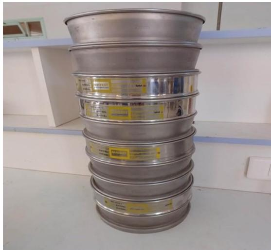
**Figure 23 : Série des tamis de 2mm jusqu'à 0.08mm**
