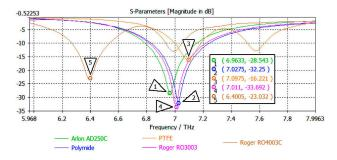
FIGURE 5. Reflection coefficient parameter S11.
