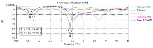
FIG. 2: Reflection coefficient parameter S11
