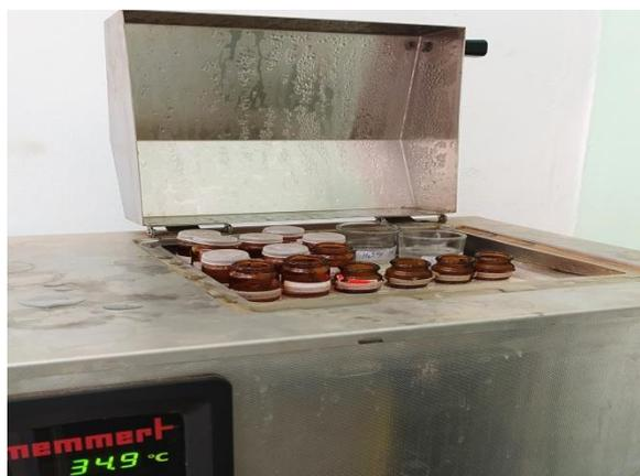
**Figure II.5 :** L'immersion des échantillons dans le bain marie
