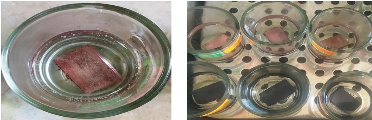
**Figure II.7 :** Le dégagement de gaz et la formation de la couche rose dans la solution de  $\text{Ag}/\text{TiO}_2$  et la couche noire dans la solution de  $\text{H}_2\text{SO}_4$  à 303 K après 3 h.
