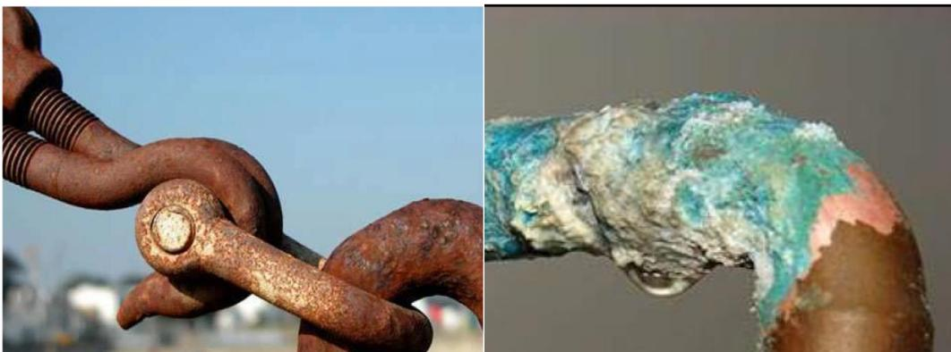
**Figure I.1** : exemples de corrosion des métaux
