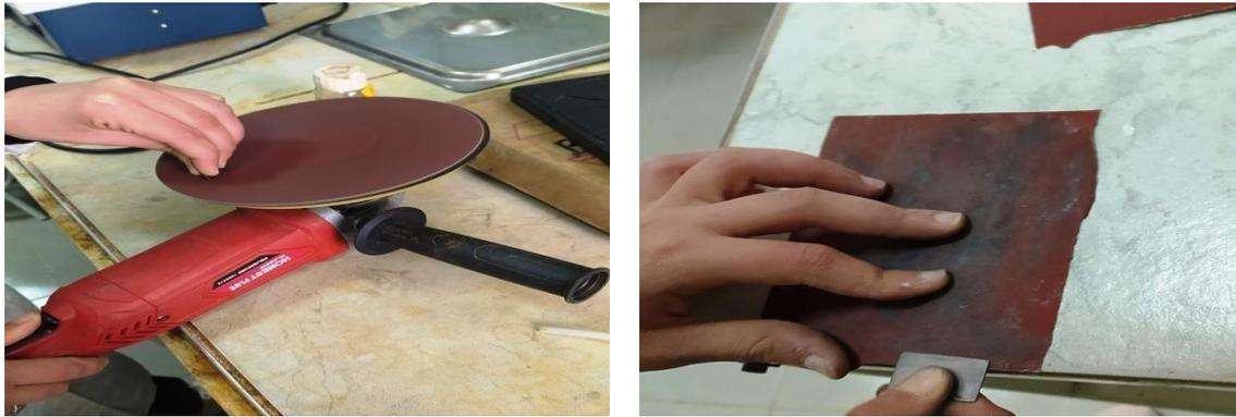
**Figure II.2 :** polissage avec le papier abrasif et polisseuse
