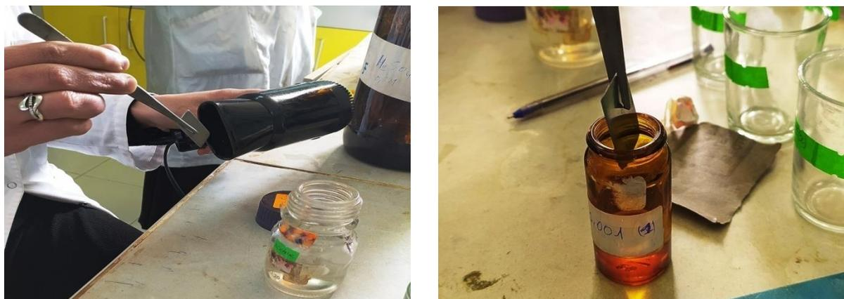
**Figure II.4 :** dégraissage, séchage et immersion des pièces.
