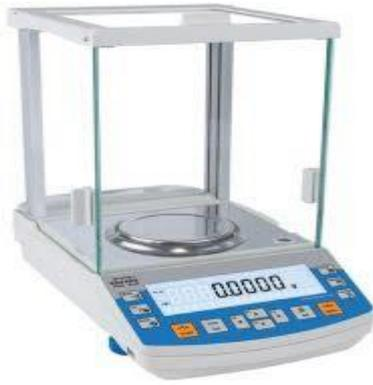
**Figure II.6 :** Balance analytique
