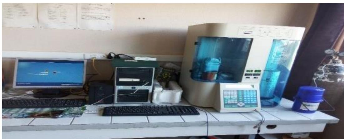
Figure II.7: Appareil de mesure BET « Nova1000 ».
