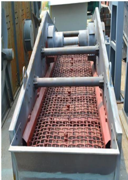
**Figure II.8** : crible vibrant.[w19]
