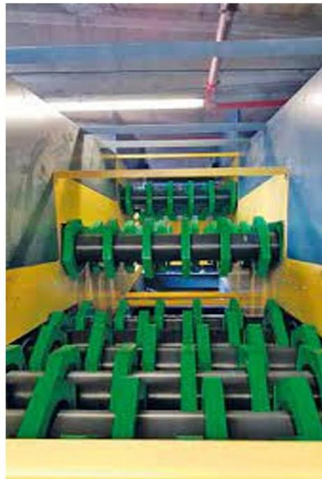
**Figure II.9** : crible rotatif.[w20]
