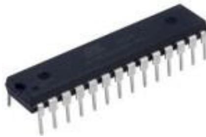
**Figure19:** Microcontrôleur ATMEL ATmega328
