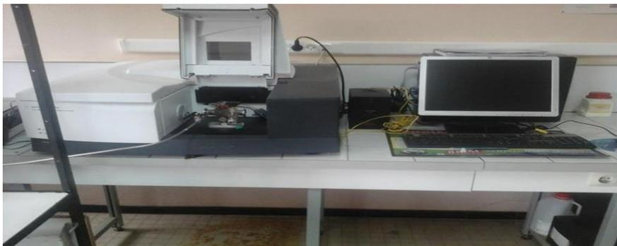
**Figure II.3 :** Appareil de Spectroscopie Infra Rouge à Transformée de Fourier.
