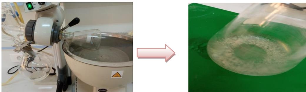
**Figure IV.7 :** L'évaporation du solvant dans un rotavapeur.
