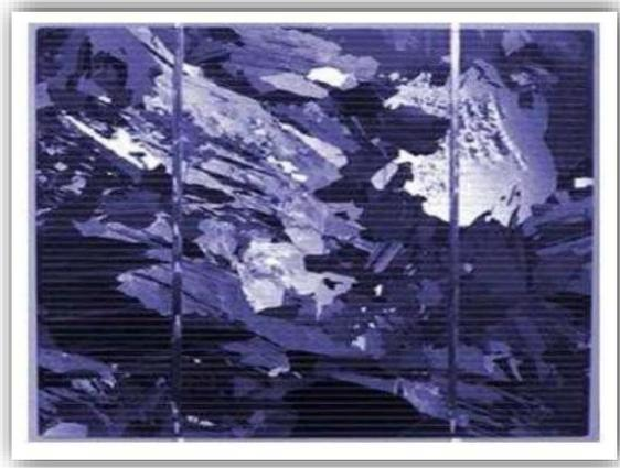
**Figure II.14 :** Silicium poly cristalline
