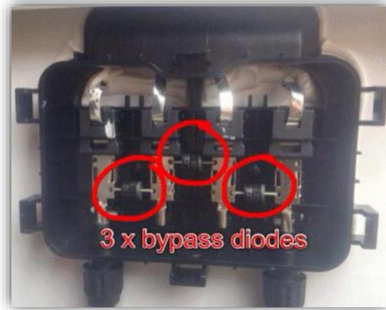
**Figure III.2 :** Schéma de Boîtier de montage avec 3 diodes anti-retours à l'intérieur
