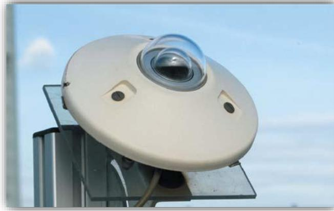
**Figure I.8 :** Pyranomètre permettant de mesure le rayonnement solaire, Tec sol [4]
