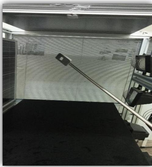
**Figure IV.6 :** Capteur de rayonnement solaire
