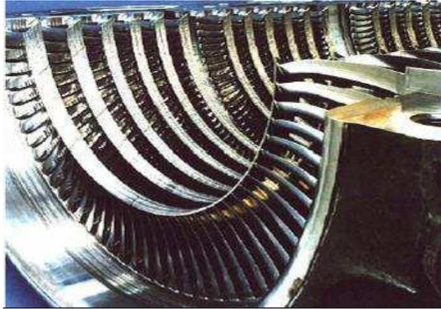
Figure I.17 : Demi-coupe d'un stator. [17]
