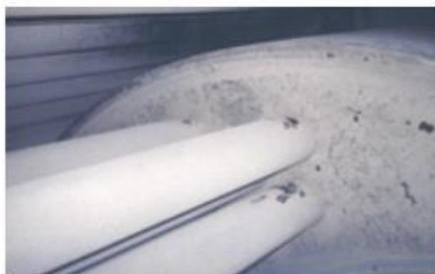
Figure I.35 : entartage d'une chaudière à tube d'un fuma .[21]
