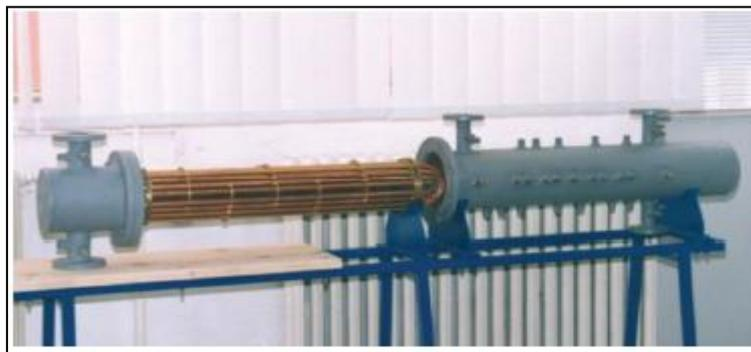
Figure II.3 :Echangeur de chaleur a faisceaux tubulaire .[28]
