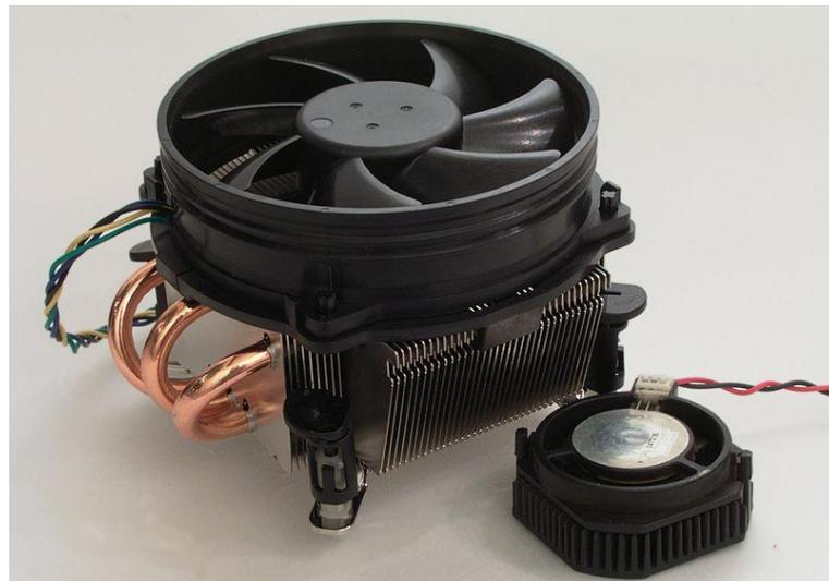
Figure I.7: Dissipateur thermique de processeur d'ordinateur avec caloduc en cuivre.
