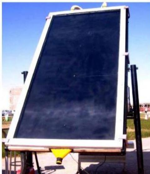
**Figure I. 08:** Capteur solaire plan à air exposé au soleil [19].
