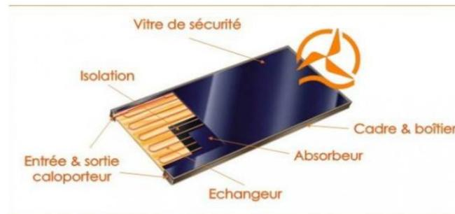
Figure I. 09 : Capteurs solaire plan vitré [20].
