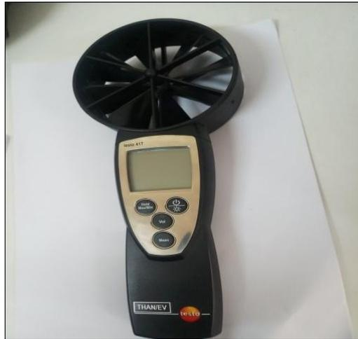
**Figure III. 06 :** Un Anémomètre multifonction.
