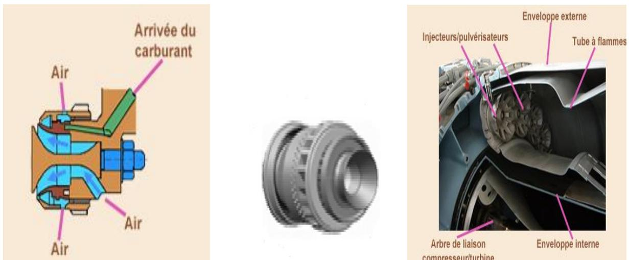
Figure I.26: dessin réalisé les injecteurs de turboréacteur Rolls-Royce [13]
