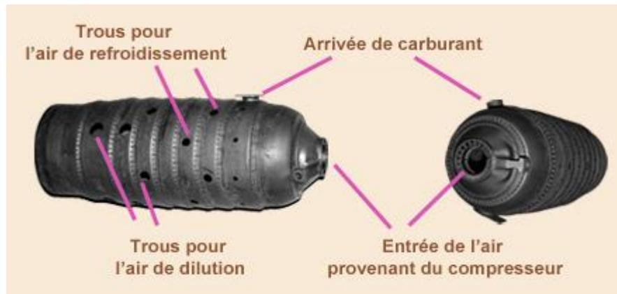
Figure I-30: la photographie d'un tube à flammes de la chambre de combustion [13]
