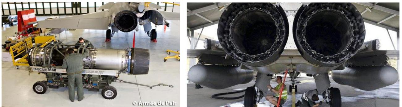
Figure I-52 : Exemple de Le turboréacteur M88. [16]
