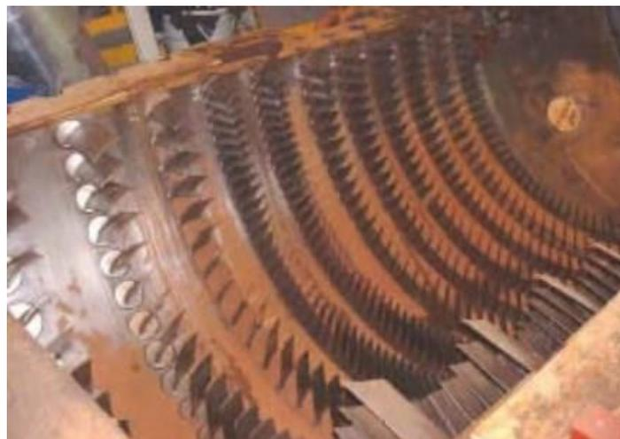
**Figure (II.10) :** Stator de compresseur à flux axial
