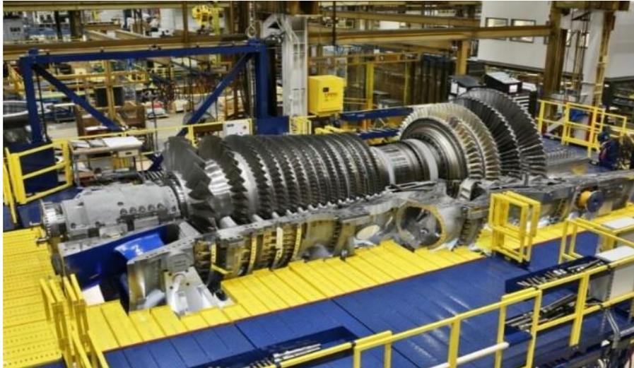
*Figure (II.8) : Compresseurs à flux axial*
