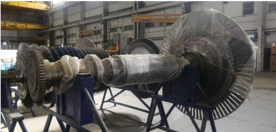
*Figure (II.18) : Turbine à flux axial*
