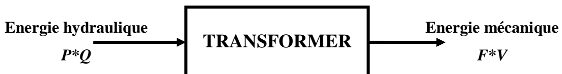
Figure II. 12. Fonctionnement d'un vérin
