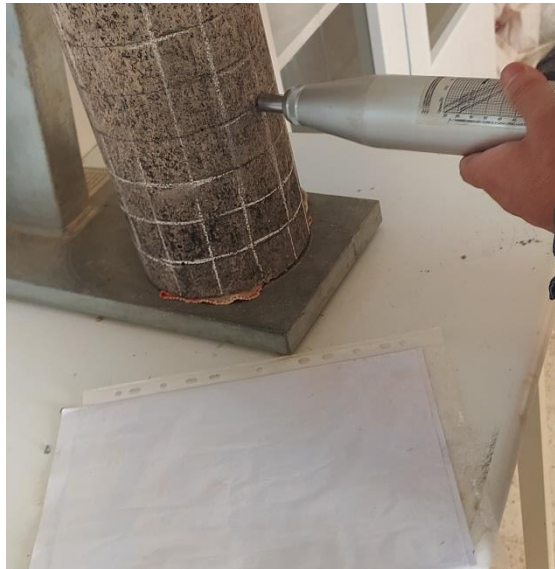
Figure-III- 11: Essai de scléromètre
