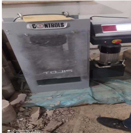
Figure-III- 12: Essai de résistance à la compression
