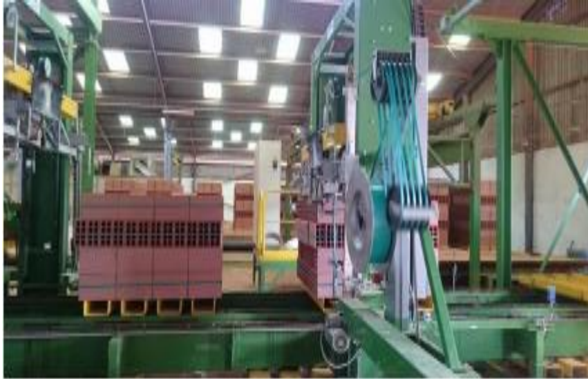
Figure III-10 : Emballage des briques[45]
