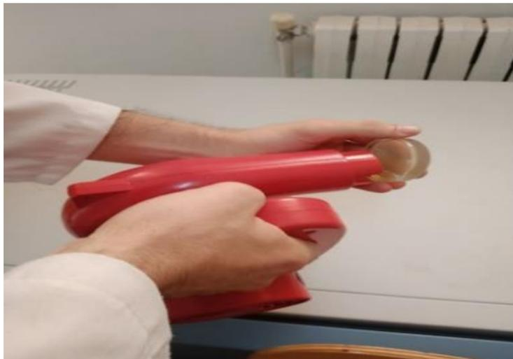
**Figure 5 :** prélèvement de l'air par la méthode du bio collecteur sur dans le compartiment à côté des étuves bactériologiques
