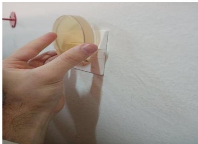
**Figure 7** : Prélèvement de la surface de l'interrupteur du laboratoire 07 par la méthode de la boîte RODAC
