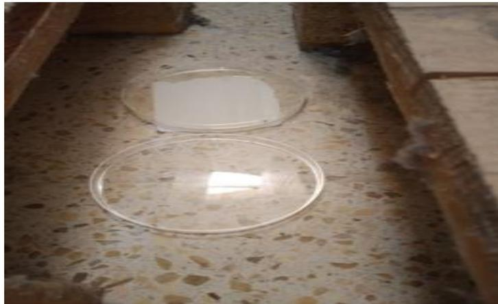
**Figure 4 :** prélèvement de l'air par la méthode de sédimentation sur dans le compartiment à côté des étuves bactériologiques
