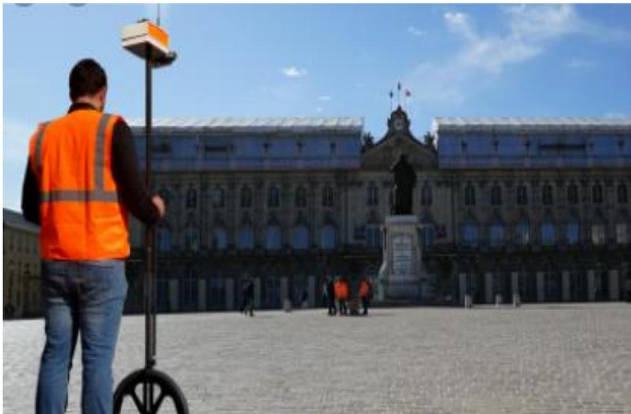
Figure 7: Appareil pour les levés architecturaux par Photogrammétrie terrestre combinais avec GPS de précision et un cymomètre.[15]
