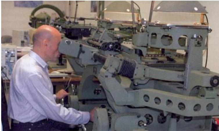
Figure 1:Photogrammétrie restituteur analogique.[3]
