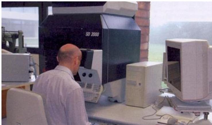
Figure 2: Restituteur analytique de photogrammétrie.[3]
