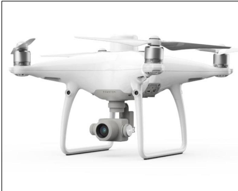
Figure 6: DJI Phantom 4 utilisé pour les relevés Photogrammétrique. [13]
