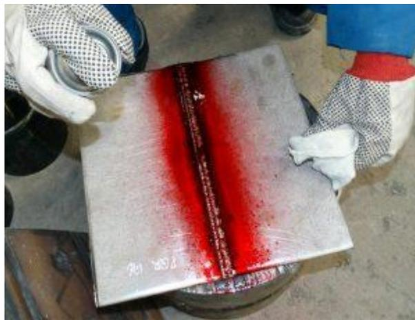
**Figure I-16-a: contrôle par ressuage**
