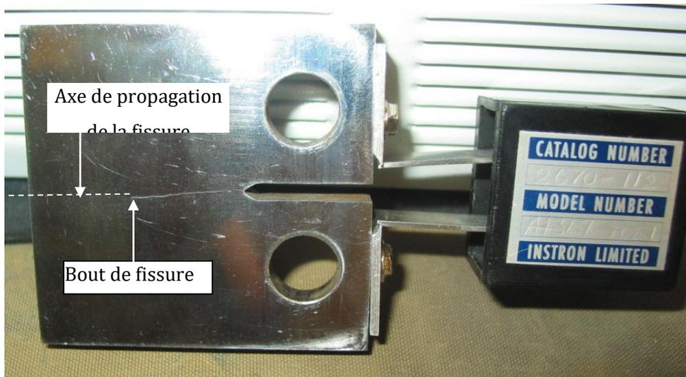
Figure II-B-8 : Position de la fissure par rapport à l'axe de propagation de la fissure
