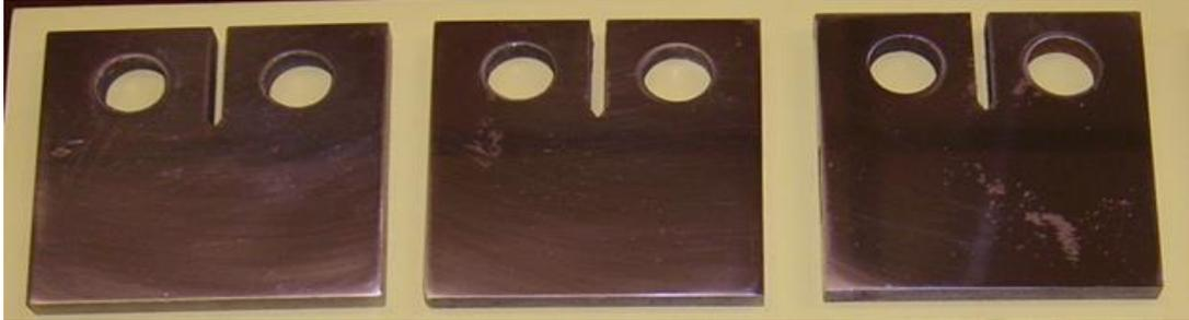
**Figure II-9** : CT50 pour les essais de fissuration.
