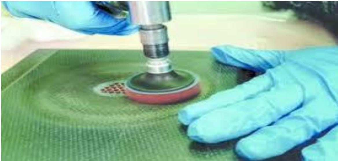
*Figure I-8- Exemple de préparation pour une réparation par patch*
