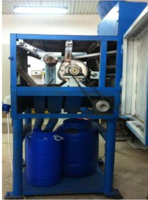
**Figure I.15** Séparateur électrostatique à tambour industriel installé à l'ERO
