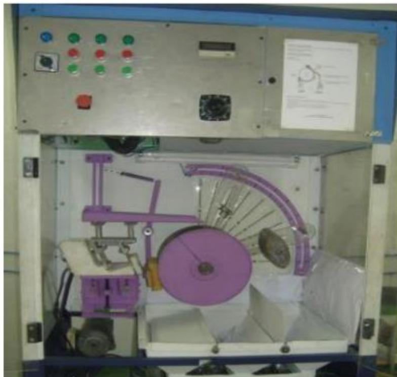
**Figure I.14:** Photographie de l'électro-séparateur réalisé au laboratoire IRECOM [49]
