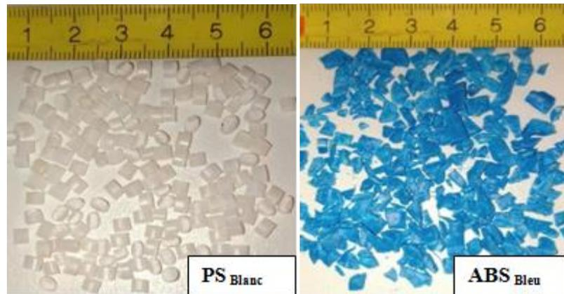
**Figure III.27:** Échantillon des granules utilisés.
