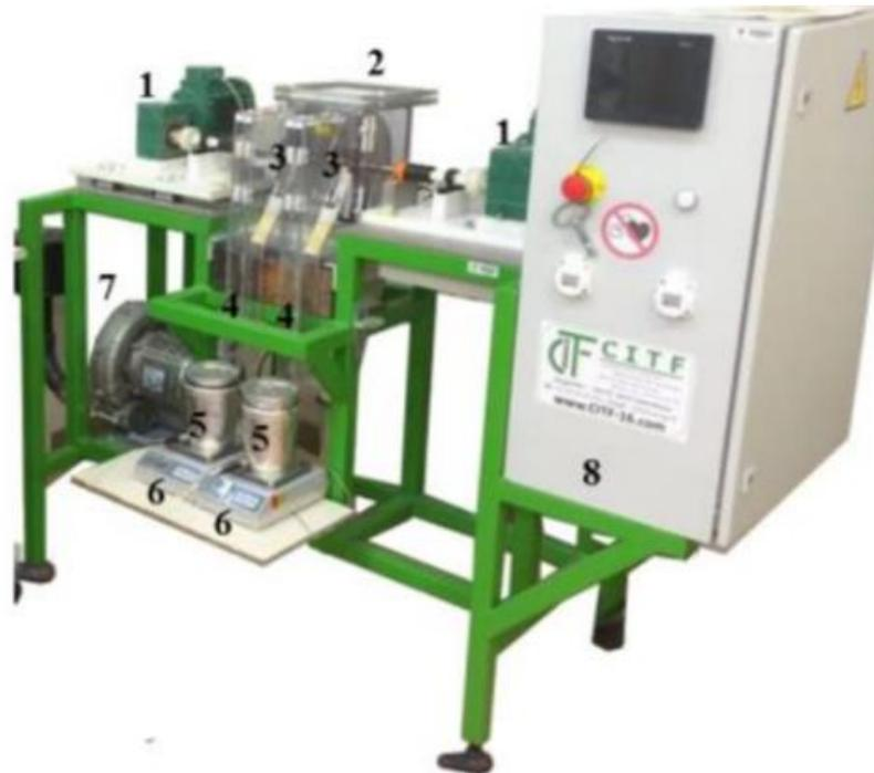
**Figure I-17:** Photographie d'un séparateur tribo-aéro-électrostatique à disques [55]. (1) Moteurs électriques ; (2) Chambre de séparation ; (3) Electrodes-disques tournants ; (4) Collecteurs ; (5) Cages de Faraday ; (6) Balances électroniques ; (7) Turbine ; (8) Armoire électrique.
