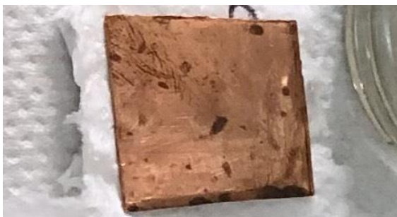
Figure1. Pièce après immersion en absence d'inhibiteur
