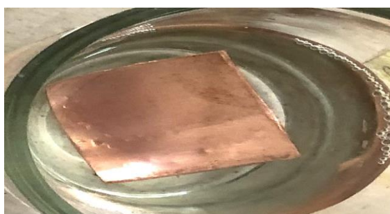
Figure2. Pièce après immersion en présence d'inhibiteur
