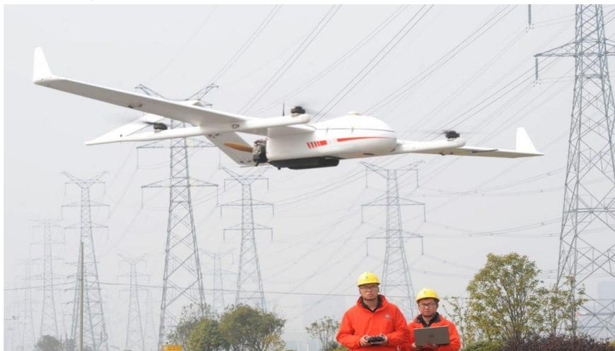
Figure II-1: Un seul pilote est nécessaire pour faire fonctionner les drones JOUAV pour les inspections des lignes électriques en chine.[41]
