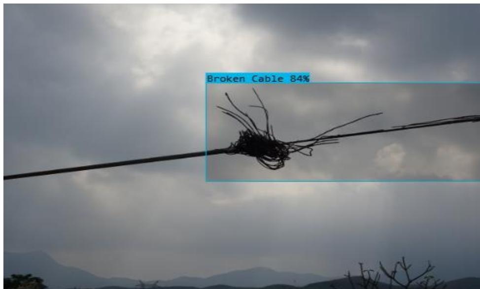
Figure II-22: détection d'un câble cassé
