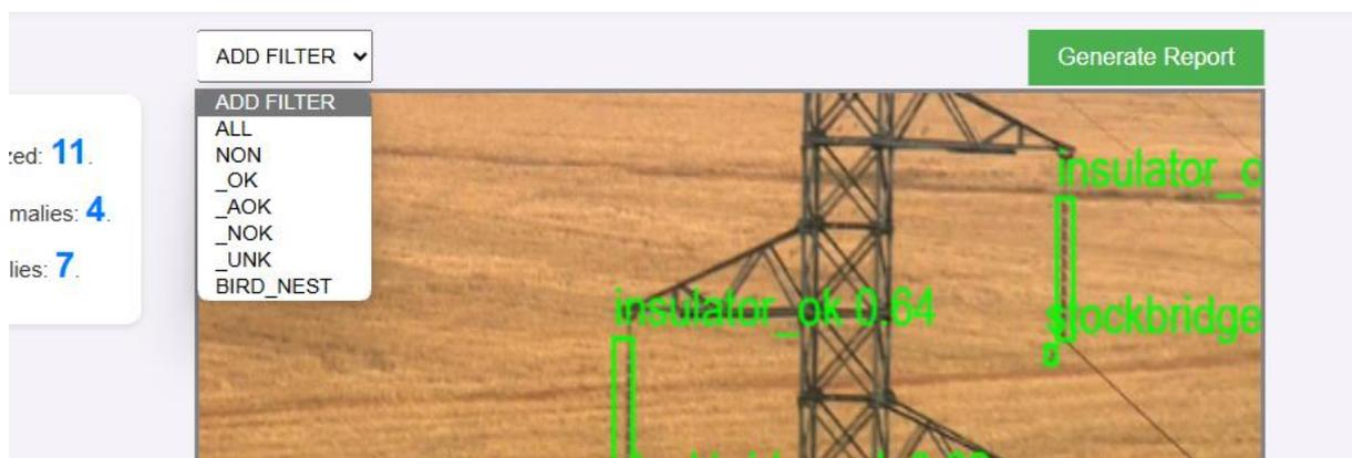
Figure II-10: Filtre pour la Classification des Anomalies
