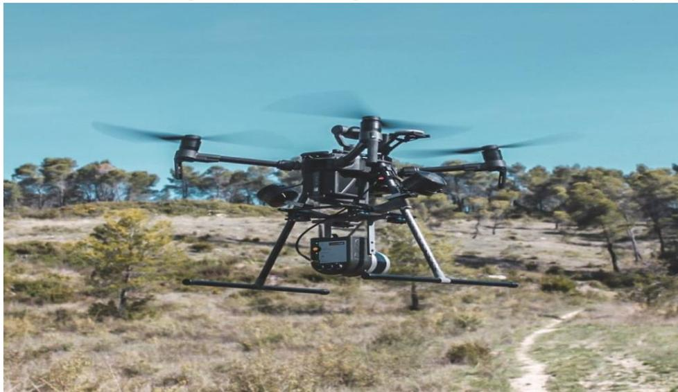
Figure II-2: Drones DJI Matrice 200 Pro avec YellowScan Surveyor UAV LiDAR [34]
