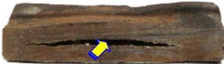
Figure I- 10 : Fragilisation par hydrogène d'une pièce métallique.
