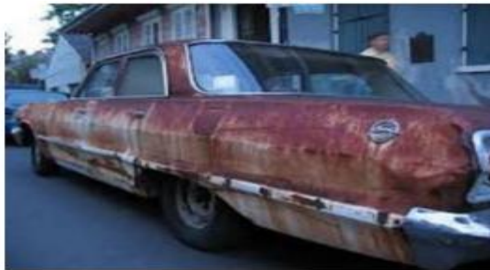
Figure I-1 : Exemple de corrosion généralisée.
