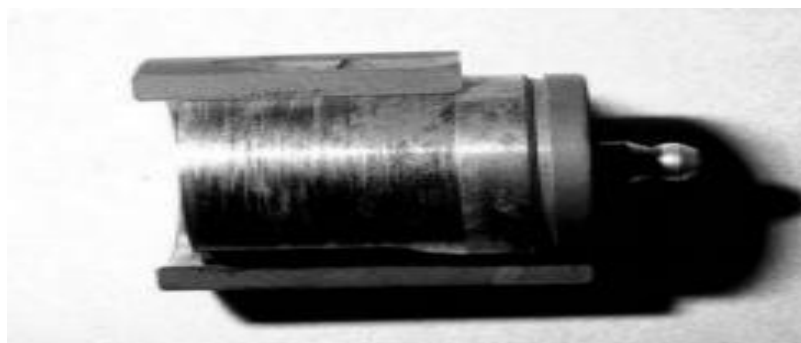
Figure I-8 : Exemple de la tribocorrosion.
