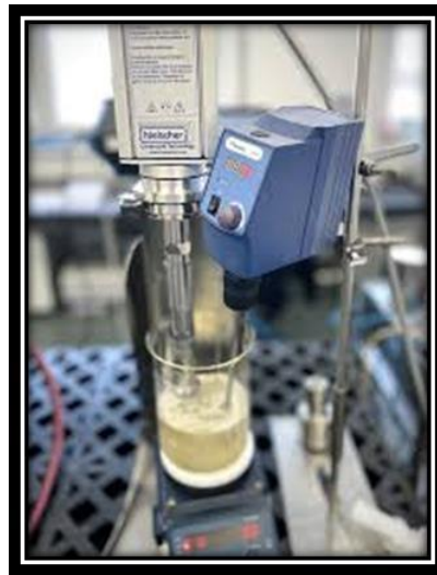
Figure I.13 : Extraction assistée par ultrasons (26)
