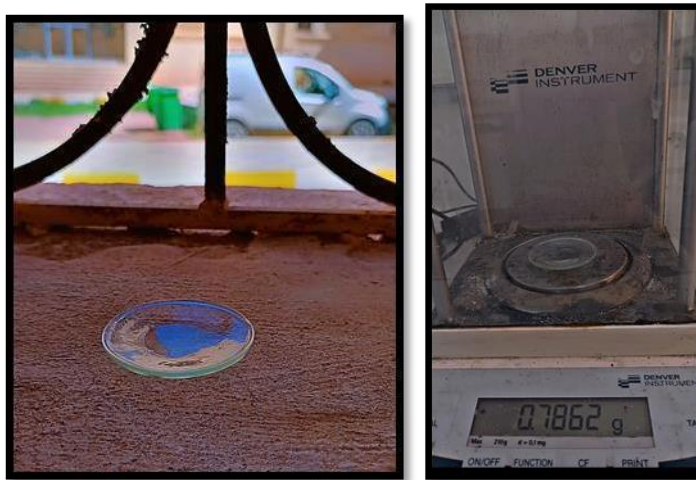
Figure II.3 : Laissez-le s'évaporer et mesurez la masse restante après 1H45MIN.
