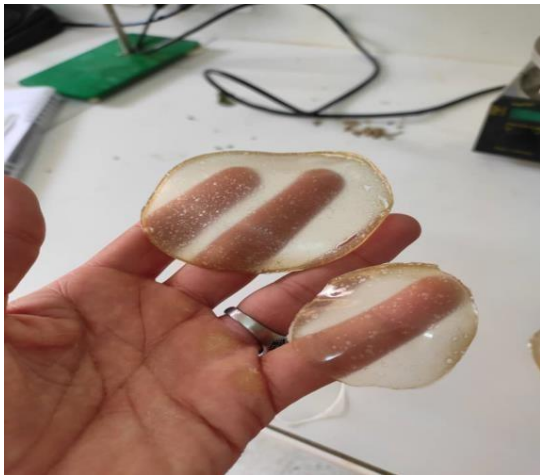
Figure III.7 : Aspect du plastique à base d'amidon avec l'extrait d'ortie
