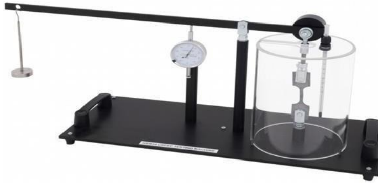
Figure III.17 : appareil de fluage. (Référence de l'appareil)
