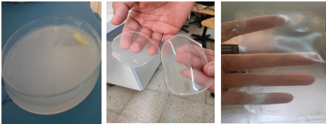
Figure III.6 : Aspect du plastique à base d'amidon
