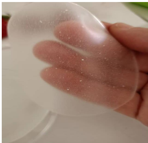
Figure III.8 : Aspect du plastique à base d'amidon 70% et 30% de polystyrène
