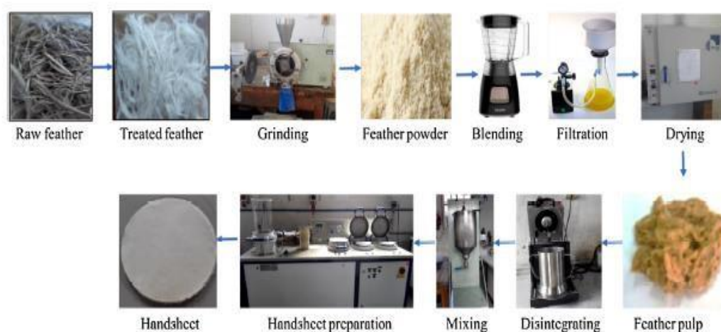
Figure 3: Diagramme de procédé pour la préparation des feuilles à main de plumes de poulet et de pâte de bois (Tesfaye et al., 2017).
