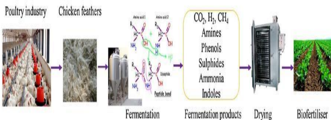
Figure 4: Schéma de la production de bio engrais à partir de plumes de poulet (Tesfaye et al., 2017).
