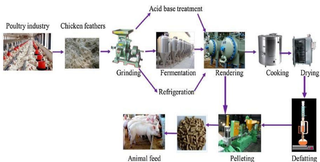
Figure 5: Schéma de la production d'aliments pour animaux à partir de plumes de poule (Tesfaye et al. , 2017).
