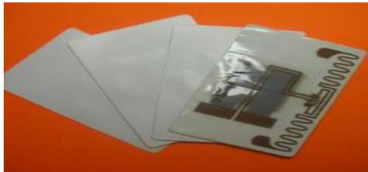
**Figure I-5 : Exemple d'un tag semi-actif**
