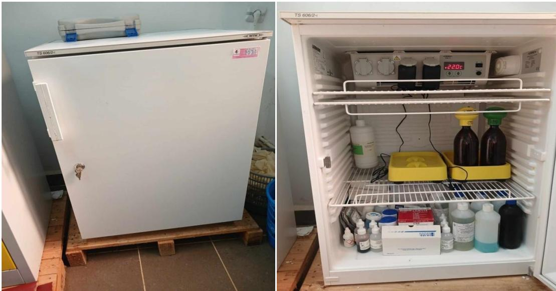
Figure 22 : Incubateur DBO de la STEP bouzagar
