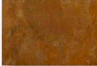
**Figure 1 :** Corrosion uniforme d'une plaque métallique.
