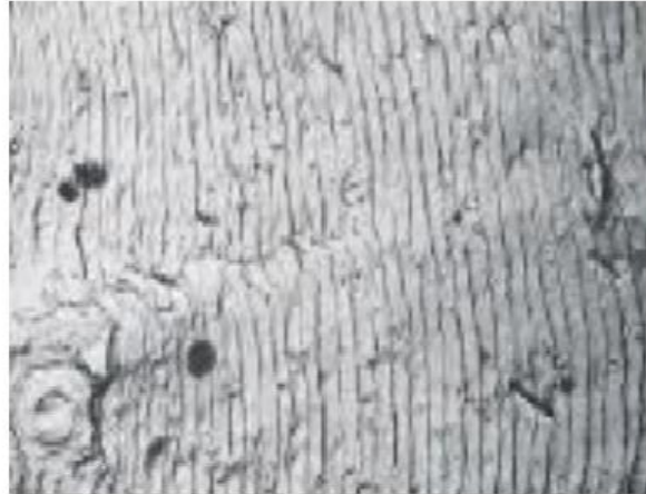
Figure 23: Rupture par fatigue d'un alliage
