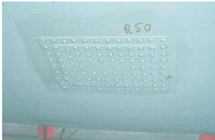
Figure 34: Réparation par patch riveté sur fuselage de Boeing
