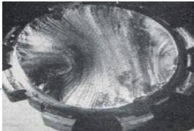
Figure 24: Rupture par fatigue d'un arbre.
