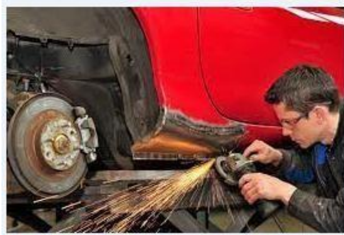
Figure 32: Réparation par soudage.
