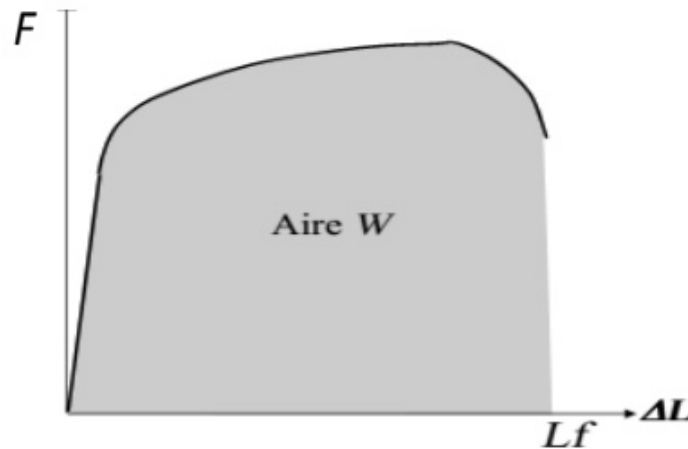
Figure 20: Mesure de la Ténacité des Matériaux : Aire sous la Courbe de Traction
