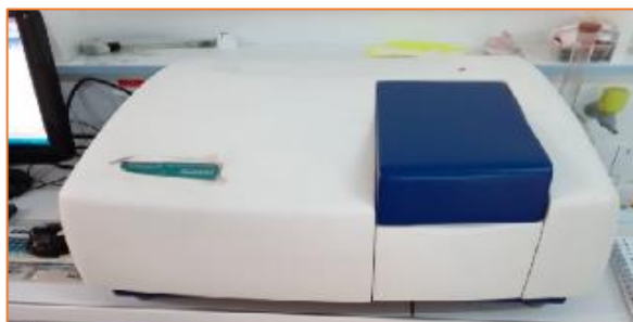
Figure B.I.1 : Spectrophotométrie d'absorption moléculaire UV-visible.
