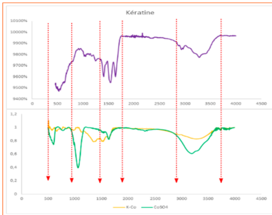
Figure C.I.15 : Spectre IR de kératine, le complexe (K-Co) et \text{CoSO}_4
