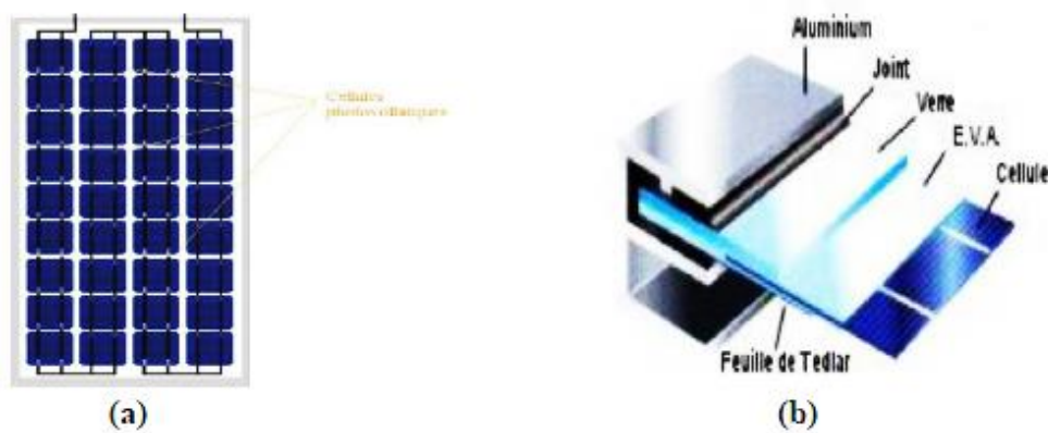
Figure (I.10) : Module photovoltaïque.
