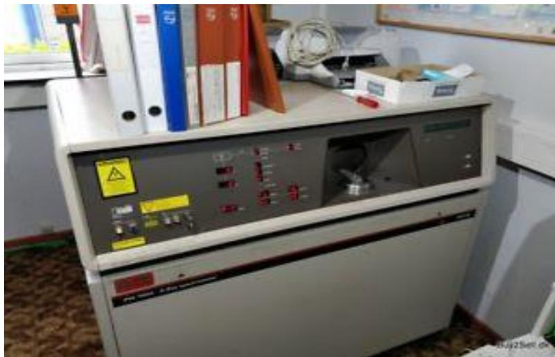
**Figure III.1** : Spectrophotomètre FRX Philips PW 1404 X utilisé
