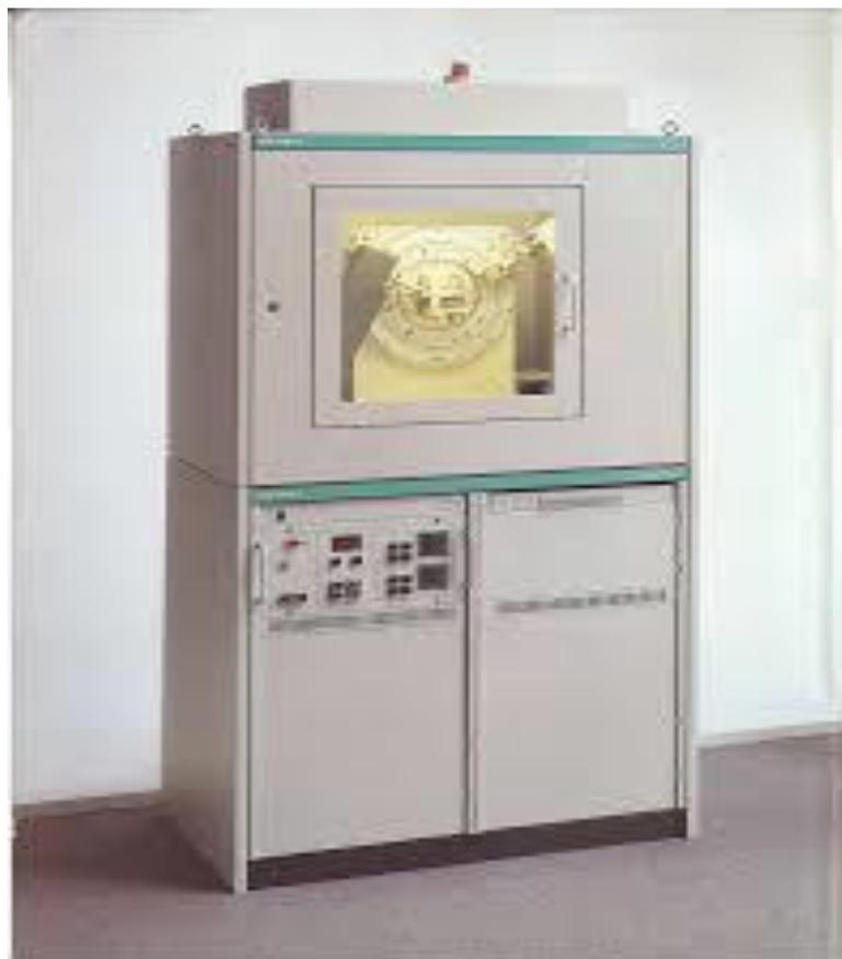
**Figure III.3 :** Diffractomètre RX *Siemens D5000* utilisé
