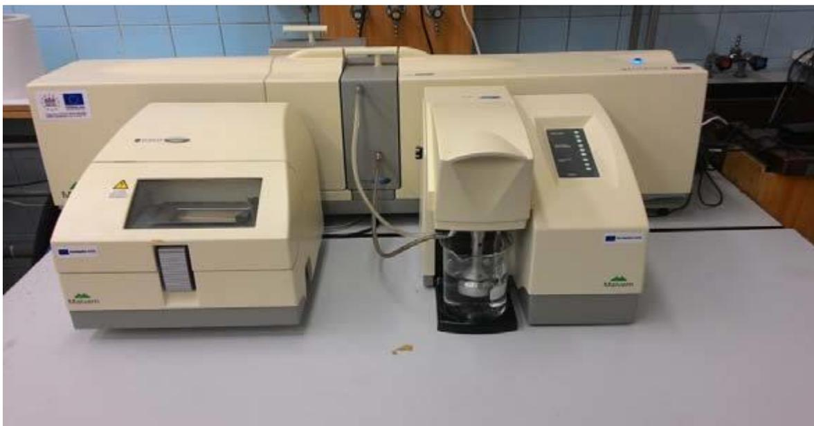
**Figure III.2 :** Granulomètre laser Masteriser 2000 utilisé
