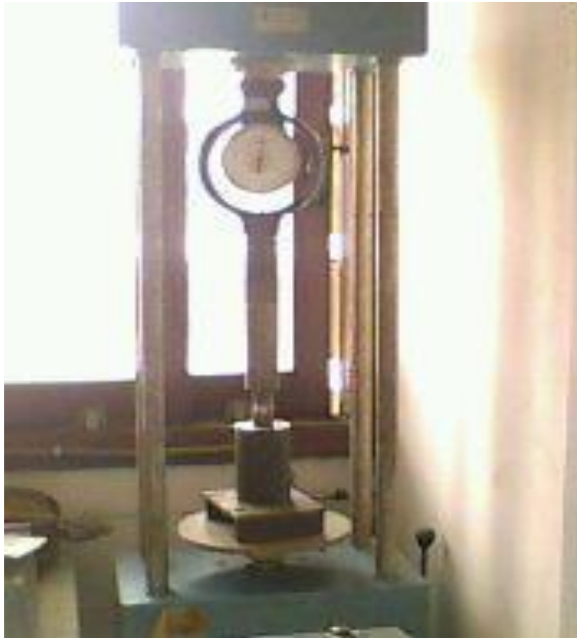
Figure16 : Dispositif expérimental de l'essai de compression
