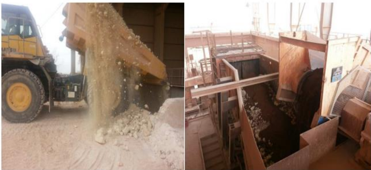
Figure 3 : Concassage des matières premières au niveau de la carrière.
