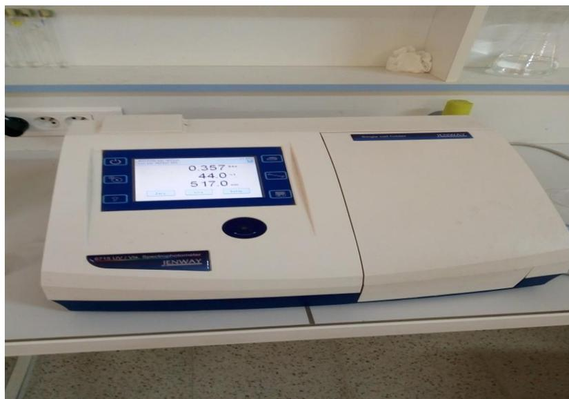
Figure B.I.2 : Spectrophotométrie d'absorption moléculaire UV-visible
