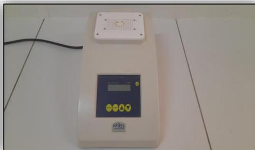
Figure B.I.1 : Appareil KRUSS de point de fusion
