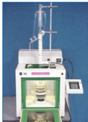
Figure A.II. 7 : Extraction par micro-onde.
