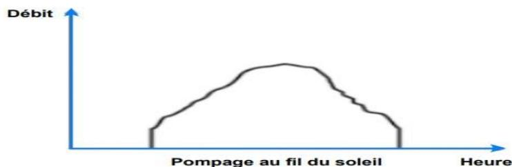
**Figure II.2** Caractéristiques du débit pour le pompage au fil du soleil. [15]
