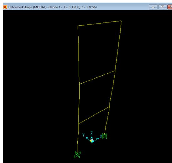
Figure 6. 5 : Période et fréquence propres dans le mode 1.
