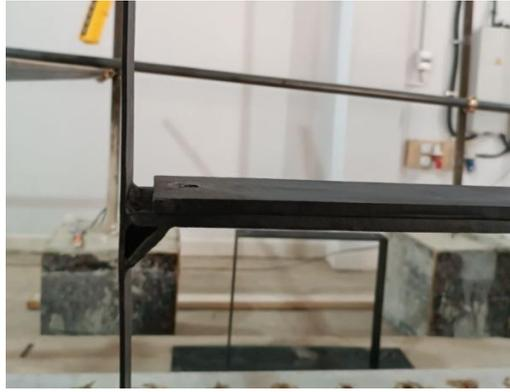
**Figure 7.4 :** Portique avec une masse ajoutée au niveau 2 (cas 2).
