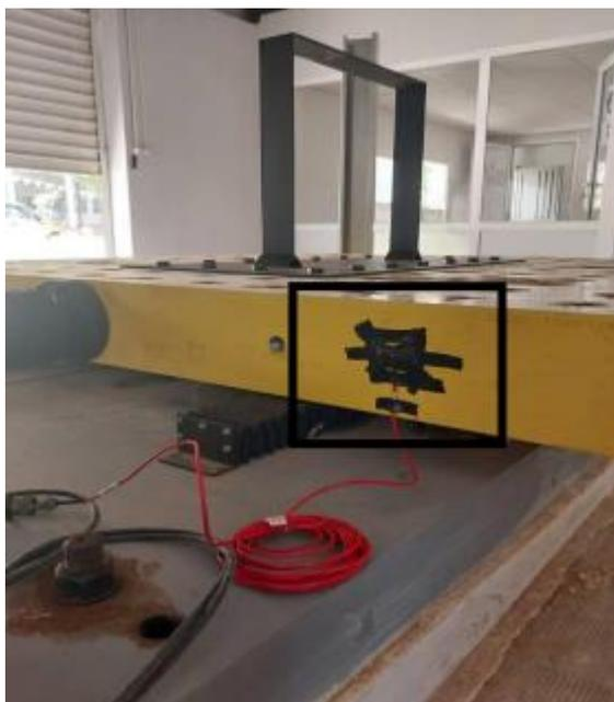
Figure 2. 19: Accéléromètre fixé au portique.
