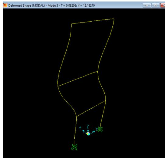
**Figure 6. 7 :** Période et fréquence propres dans le mode 3.
