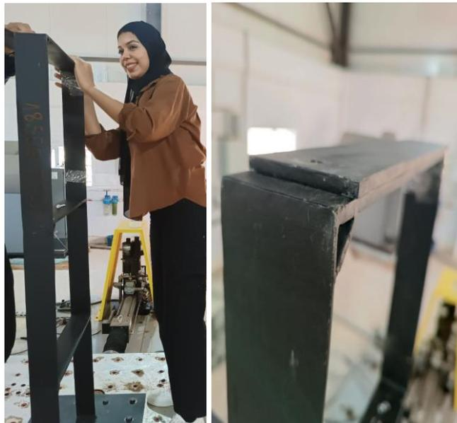
**Figure 7.3 :** Portique avec une masse ajoutée au niveau 3 (cas 1).
