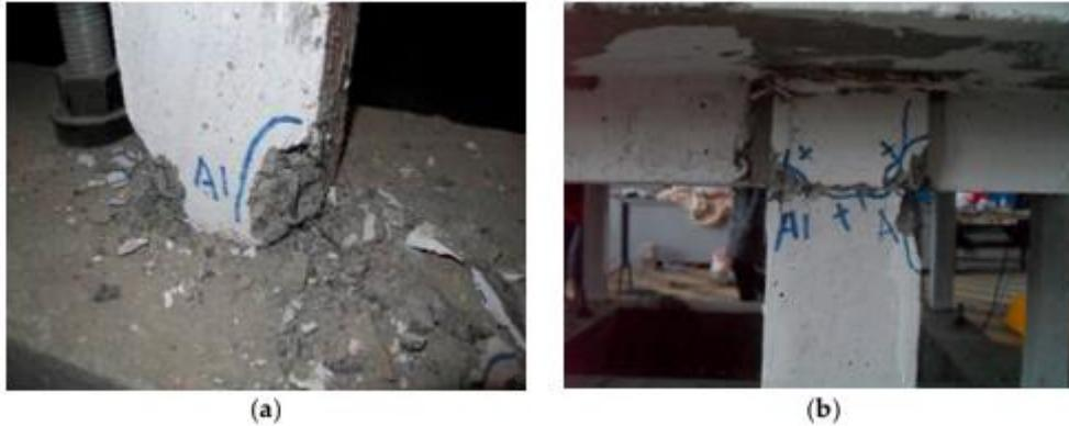
**Figure 2. 15:** Dommage du modèle après l'exécution 6 (a) Flambage de l'armature à l'emplanture du poteau ; (b) Béton écaillé à l'extrémité du poteau.
