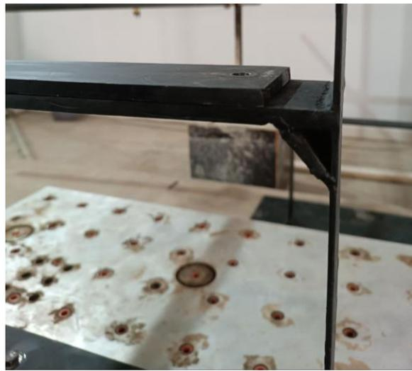
**Figure 7.5 :** Portique avec une masse ajoutée au niveau 1 (cas 3).
