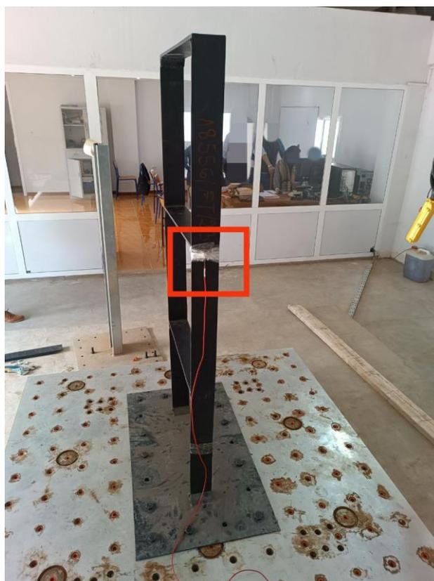
**Figure 5. 22 :** Accéléromètre fixé au niveau 2 du portique.
