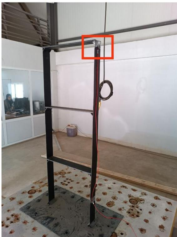
**Figure 5. 21 :** Accéléromètre fixé au niveau 3 du portique.
