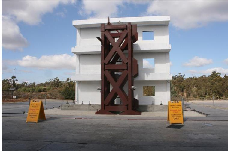
**Figure 2. 7:** Un bâtiment historique modernisé survit à de fortes secousses simulées lors d'un test de l'université de Californie à San Diego. (Jacob,2009)
