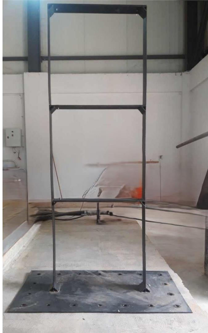
**Figure 5. 2:** Portique en acier a un système de trois degrés de liberté.
