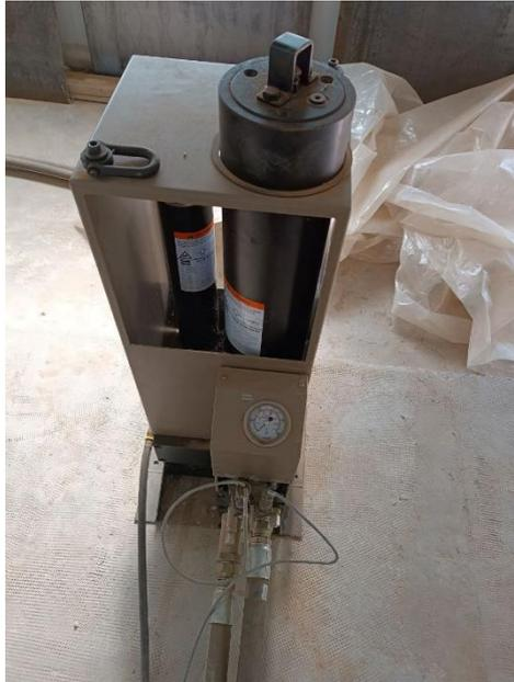
**Figure 1. 27:** Service hydraulique collecteur (HSM) de la table vibrante de RISAM.
