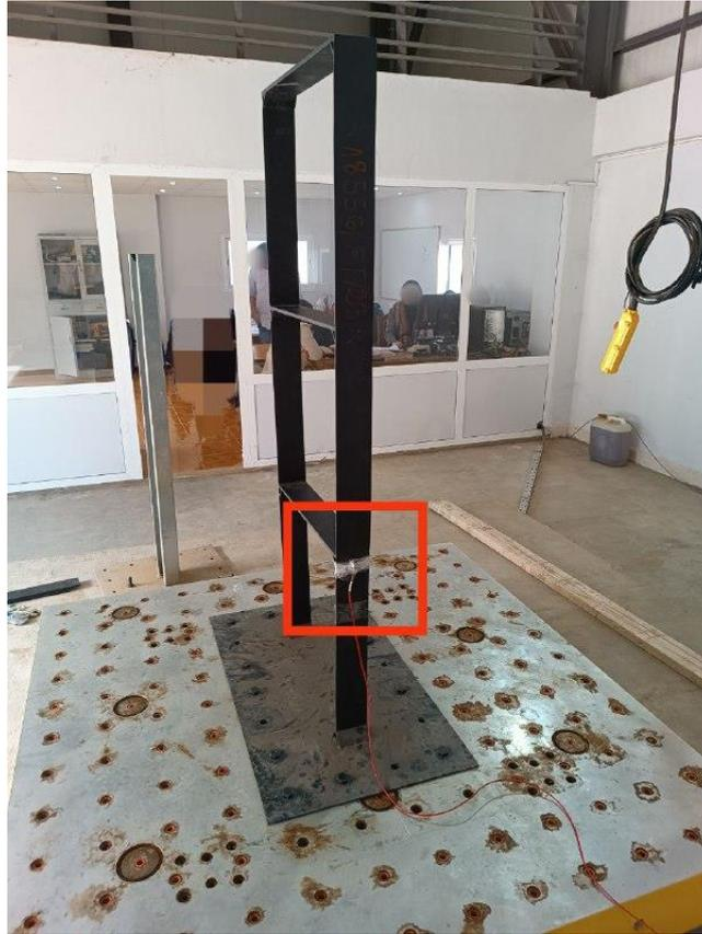
Figure 5. 23 : Accéléromètre fixé au niveau 1 du portique.
