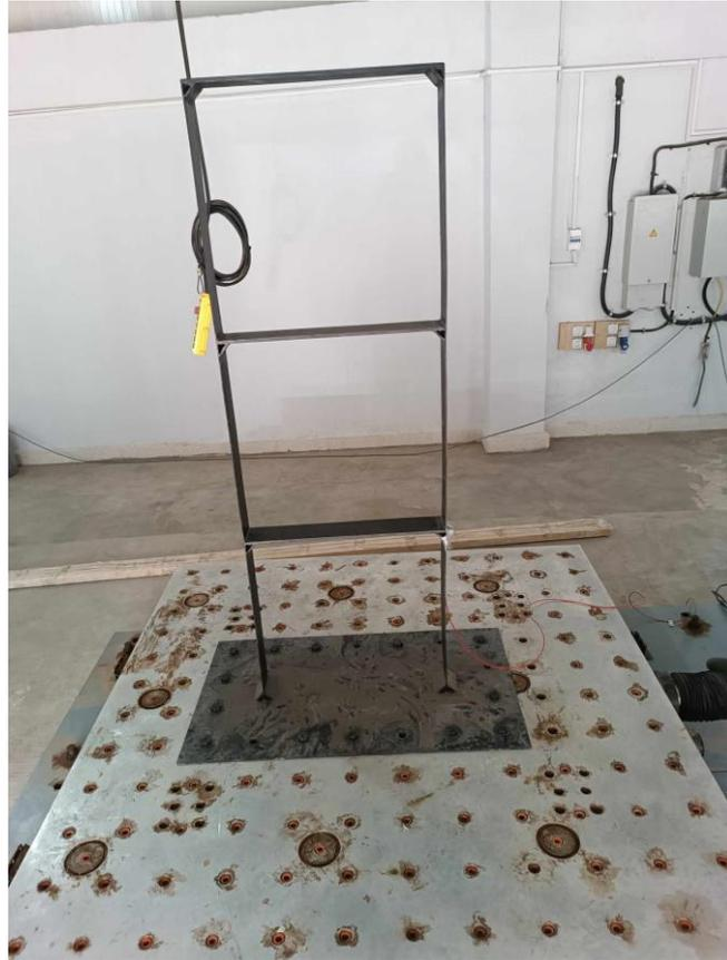
**Figure 5. 19** : spécimen fixé sur la table vibrante.
