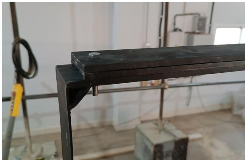
**Figure 7.6 :** Portique avec deux masses ajoutées au niveau 3 (cas 4).
