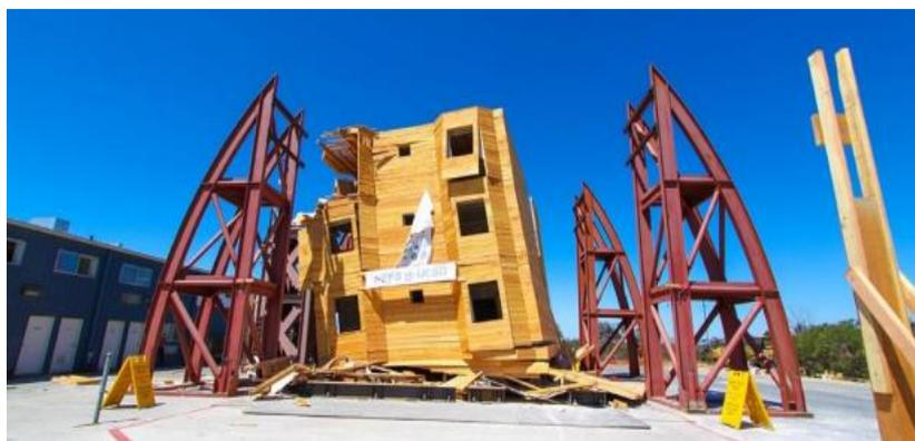
**Figure 1. 13:** Test d'un bâtiment à ossature de bois de quatre étages sur la grande table vibrante extérieure de l'université de Californie, San Diego. (ASCE, 2021)
