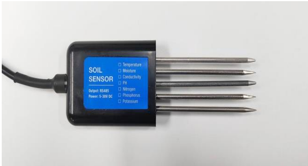
Figure 5 : Capteur du PH, NPK, Humidité, Température
