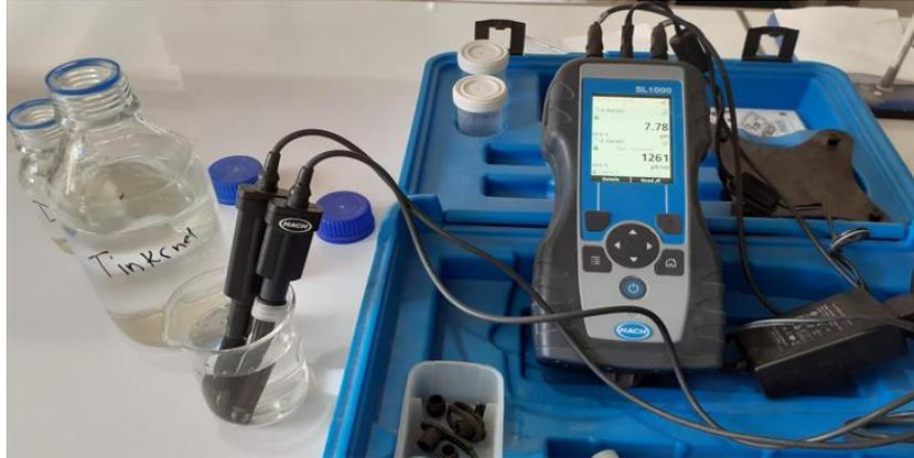
**Figure 7:** Mesure de pH, de température et de conductivité.
