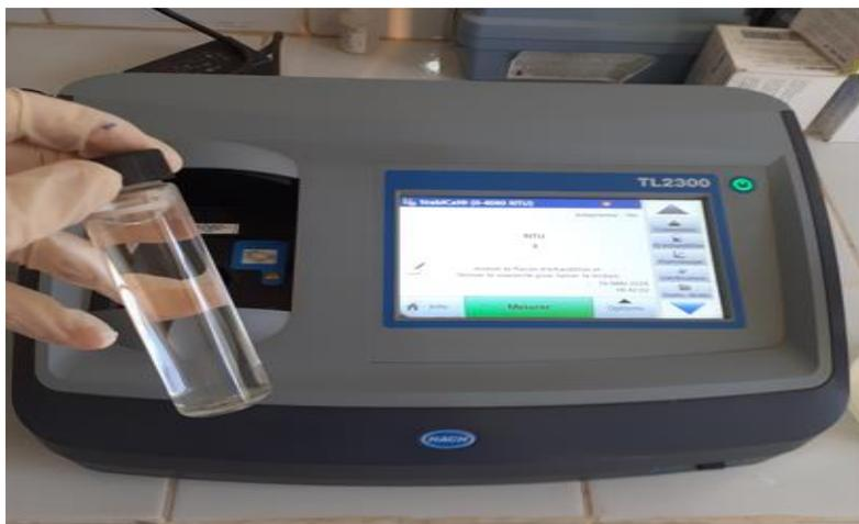
**Figure 6 :** Turbidimètre.
